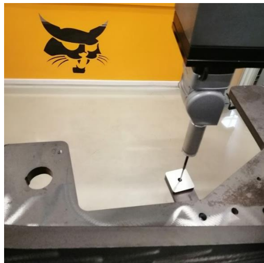
Obr. 71 Snímanie diery v prímernom prípravku A (Kružnica K007)
