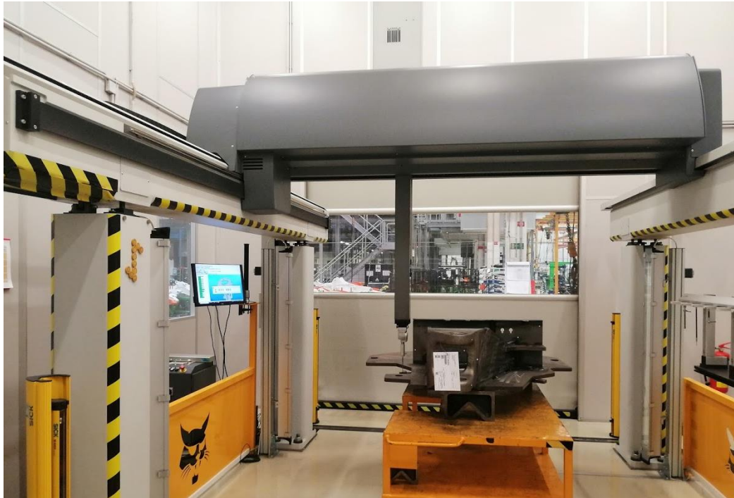
Obr. 70 Priebeh merania rámu na CMM Alpha DEA
