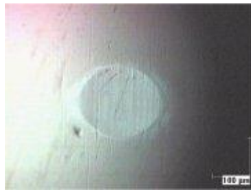
Obr. 11 Abrasívny oter rubinovej guličky pri skenovaní liatiny. Riešenie: zirkoniová gulička [22]
