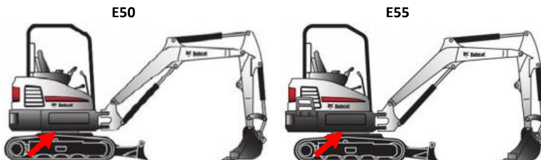
Obr. 27 Kompaktné rýpadlo Bobcat typu E50 a E55. Červené šípky nazačujú umiestenie kontrolovanej rámu v rýpadle. [47]
