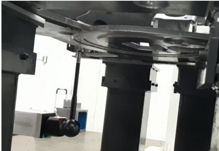
Obr. 60 Kontrola ložiskovej plochy rámu rýpadla na CMM s dvomi horizontálnymi ramenami
