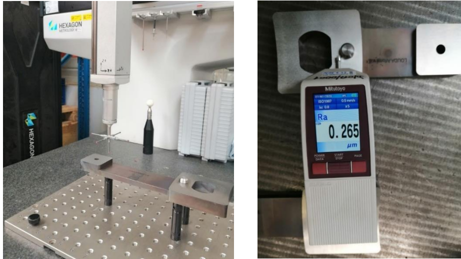
Obr. 62 Meranie metrologických parametrov. Vľavo meranie geometrických rozmetov na CMM Tigo SF. Vpravo meranie drsnosti príložných a meracích pôch drsnomerom Surftest SJ-210 Mitutoyo.
