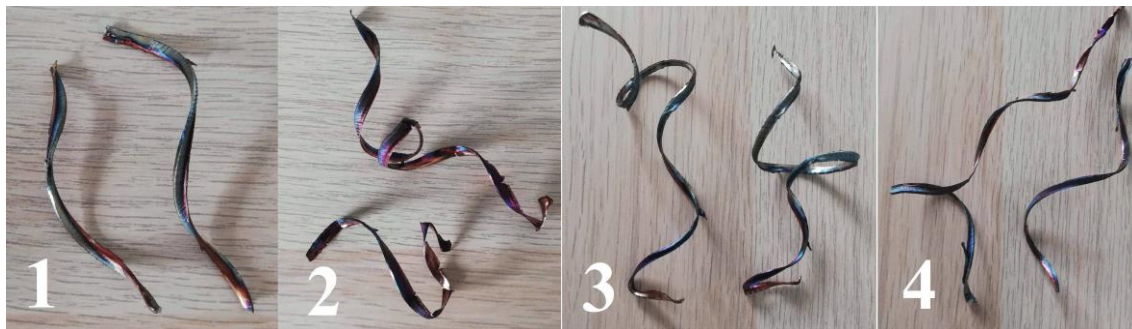
Obrázek 57: Tvary třísek po zkoušce silového zatížení pro jednotlivé nástroje
