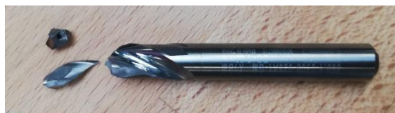
Obrázek 56: Destrukce vrtáku č. 1 po měření silového zatížení
