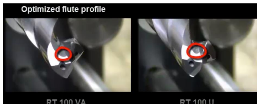
Obrázek 23: Porovnání tvaru drážky RT 100 VA a RT 100 U [29]
