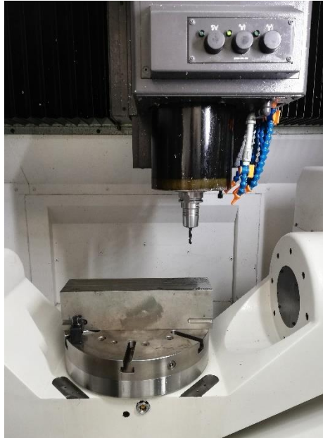
Obrázek 58: Upnutí obrobku na pracovní stůl stroje Okuma MU-400 V II
