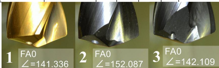
Obrázek 43: Měření úhlu hrotu 2\kappa_r
