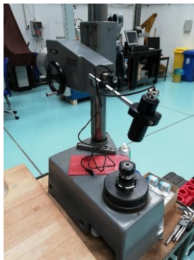
Obrázek 47: Kamera a držák s kleštinovým upínačem v poloze pro měření opotřebení na hřbetu
