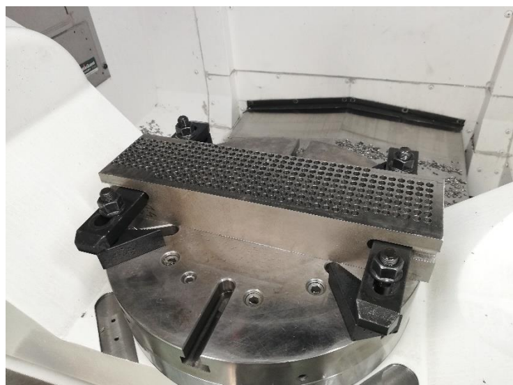
Obrázek 75: Stav obrobku po provedení vrtacích zkoušek
