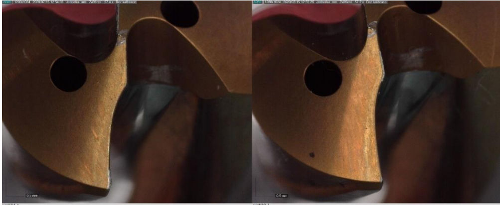
Obrázek 61: Stav obou hřbetů vrtáku č. 1 po vyvrtání prvního otvoru ( t = 0,06 min)
