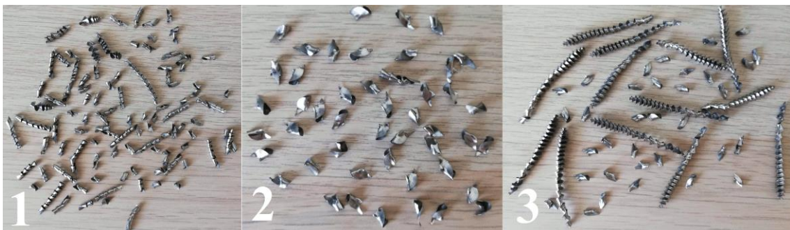
Obrázek 73: Porovnání tvaru utvářených třísek v průběhu celého testování opotřebení bříty
