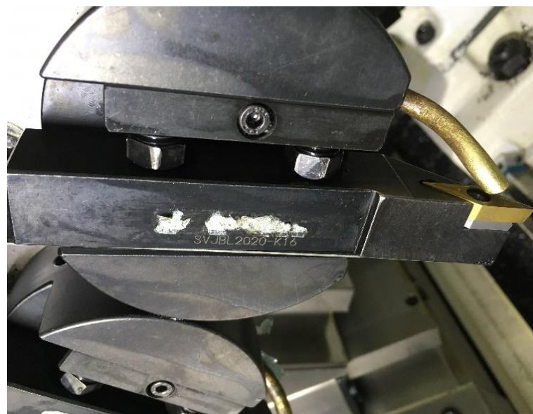
Obrázek 47: Dokončovací nůž opatřen přidavnou měděnou trubičkou
