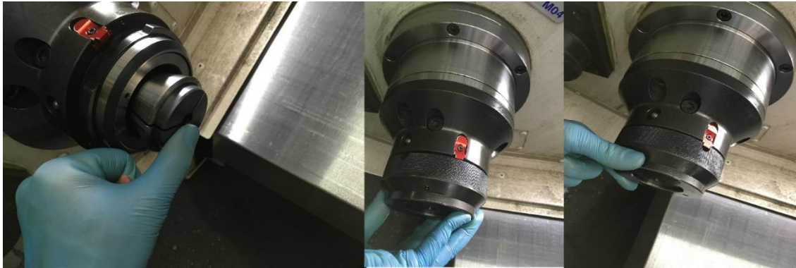
Obrázek 46: Sestavení a zajištění kleštiny v upínači
