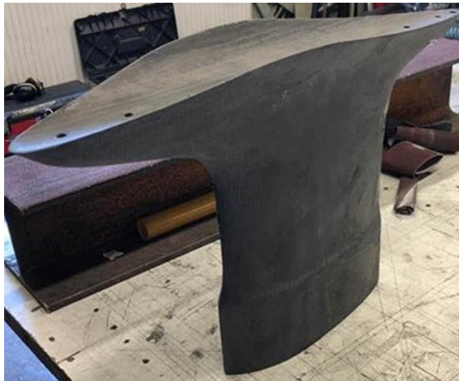
Obrázek 3.7: Součást lodi od firmy CompoTech vyrobená metodou kladení
