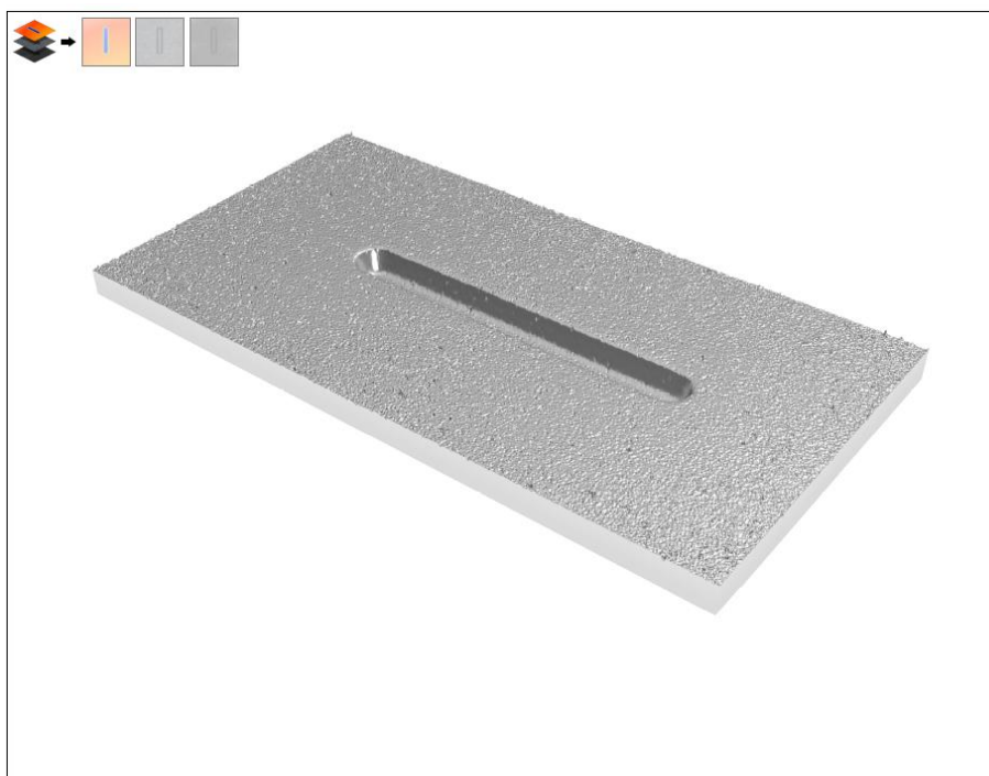
Obrázek 42 - Použití Gaussova filtru 0,025 mm
