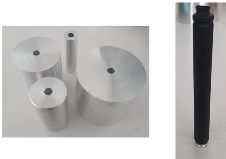
Obrázek 34 - Vyrobené prstence a zatavený etalon pomocí teplem smrštitelné izolace
