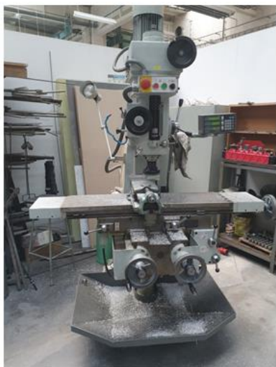
Obrázek 29 - Frézování: a) Frézka F2V Lux b) Konečný hranol
