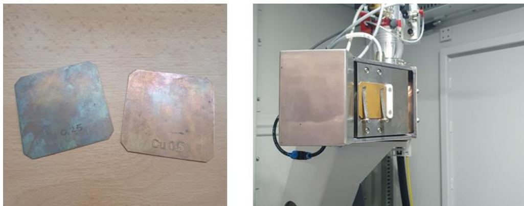
Obrázek 46 - Použitý filtr a jeho umístění v CT
