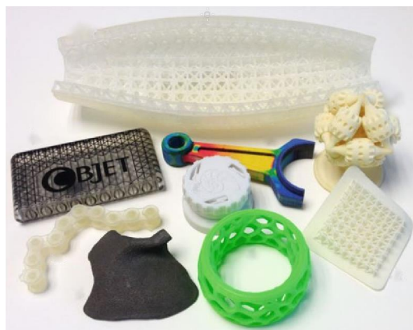
Obrázek 10 - Tvarově složité součásti vyrobené aditivními technologiemi [1]
