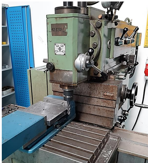
Obrázek 37 – Odstraňování stop po laserovém řezání frézováním
