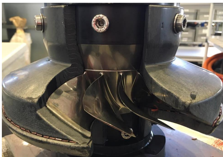
Obrázek 48 - Vyleštěná část lopatkového kola
