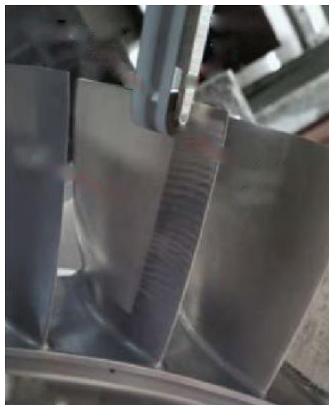
Obrázek 14 - Leštění lopatek brusným pásem [11]
