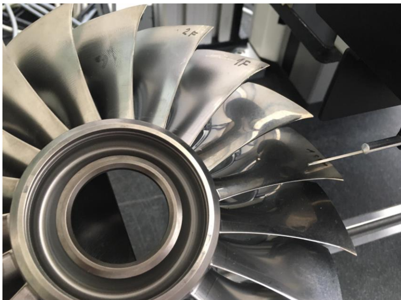
Obrázek 50 - Měření drsnosti povrchu leštěné lopatky
