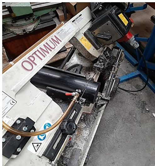
Obrázek 33 – Dělení polotovaru na pásové pile OPTIsaw S 181 G
