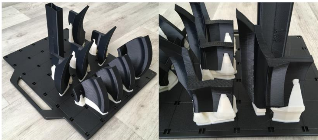
Obrázek 40 - Vytisknuté krycí segmenty
