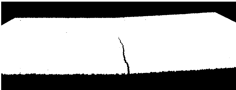
Obrázek 55 Tomografický snímek trhliny u vzorku 09_PT v softwaru MyVGL 3.2.3
