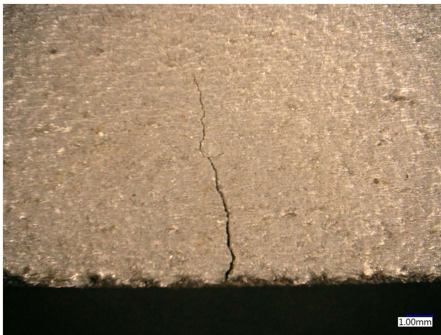
Obrázek 57 Trhlina vzorku 10_OT6
