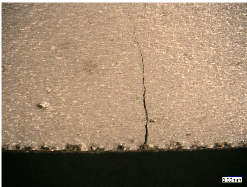
Obrázek 48 Trhlina u vzorku 01_RD3
