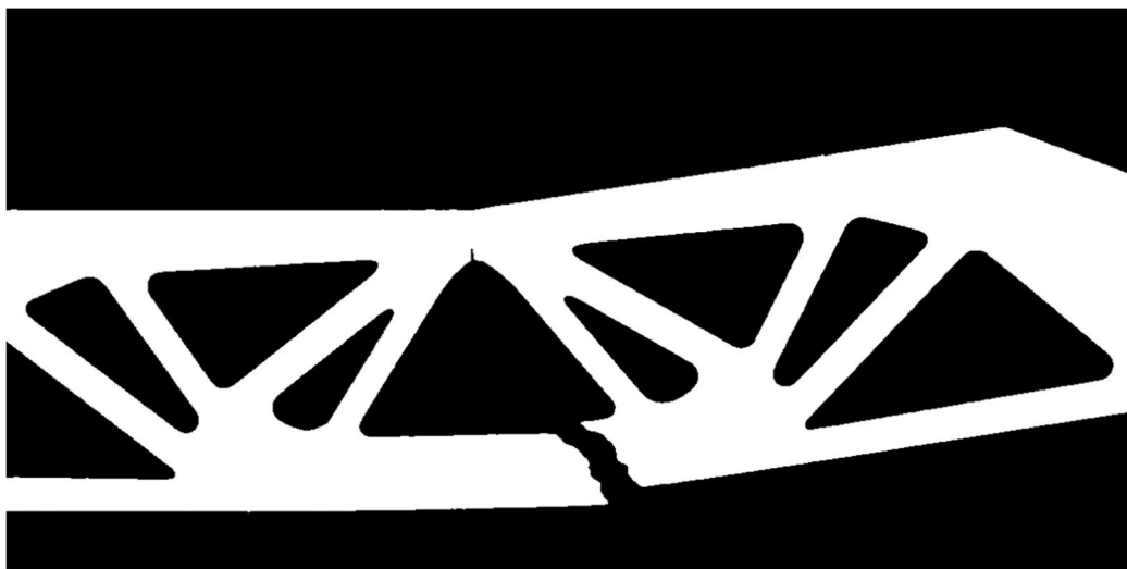
Obrázek 64 Tomografický snímek trhliny u vzorku 16_TOP v softwaru MyVGL 3.2.3
