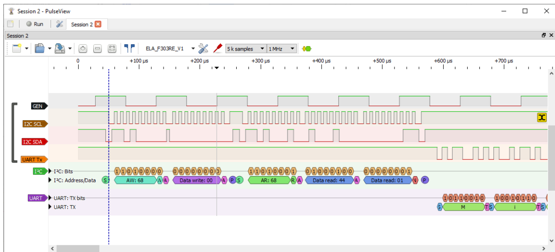
Obrázek C.2. Ukázka analýzy komunikace I2C.
