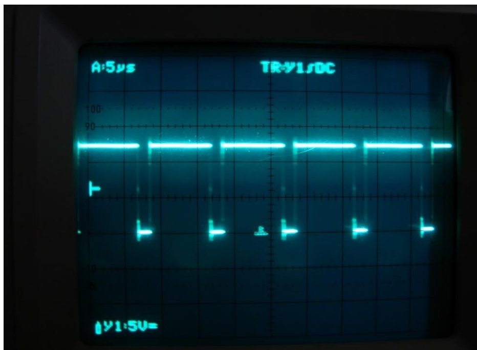
Obr. 50: Řídicí signál po připojení filtračního kondenzátoru, SEPIC 5/30, 470 \mu\text{H} , 100 kHz, 60 mA
