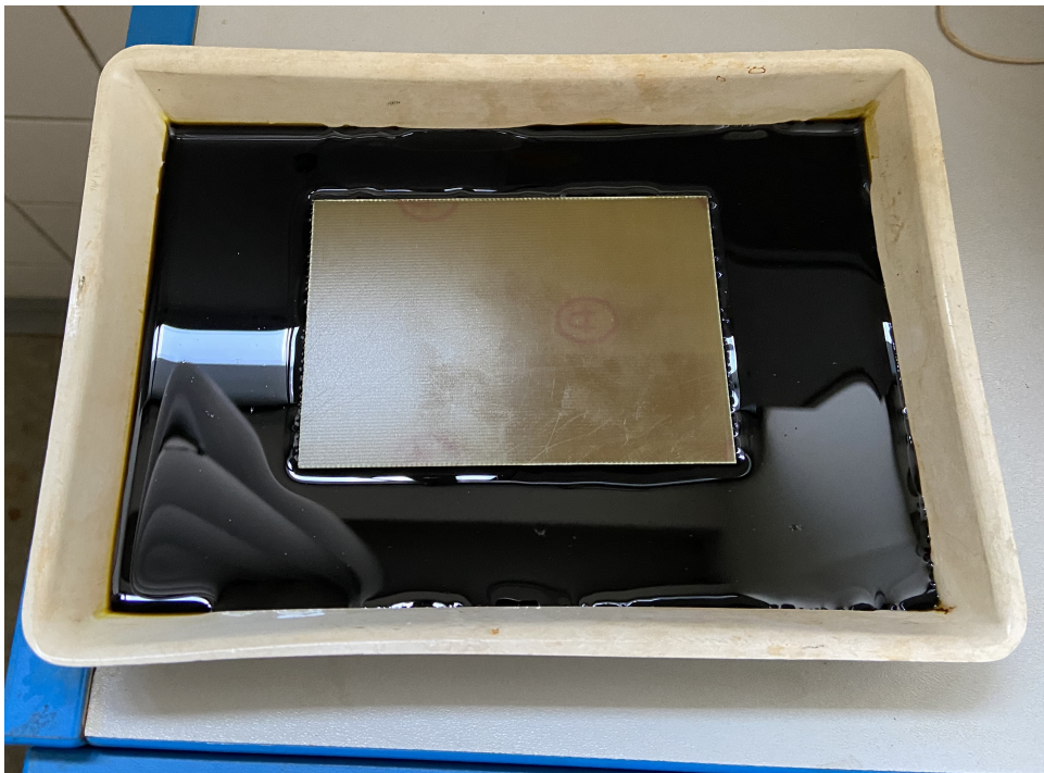
Obrázek A.4: Leptání desky v leptacím roztoku
