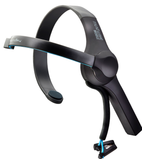
Obrázek 3.1: Čelenka pro měření EEG, Neurosky mobile mindWave2
