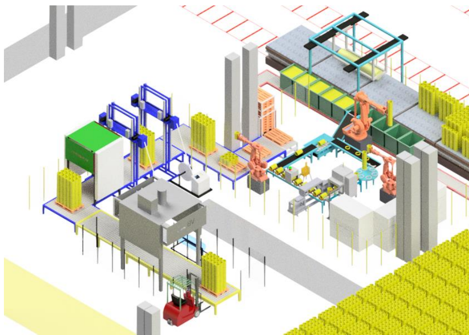
Obrázek 66 Plně automatizovaná kontrolní linka
