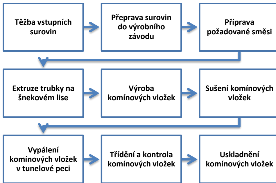
Obrázek 26 Výrobní proces komínové vložky
