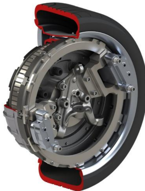
Obr. 7: Řez elektromotorem v kole [8]
