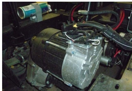
Obr. 9: Pohonné ústrojí elektromobilu Goupil [6]
