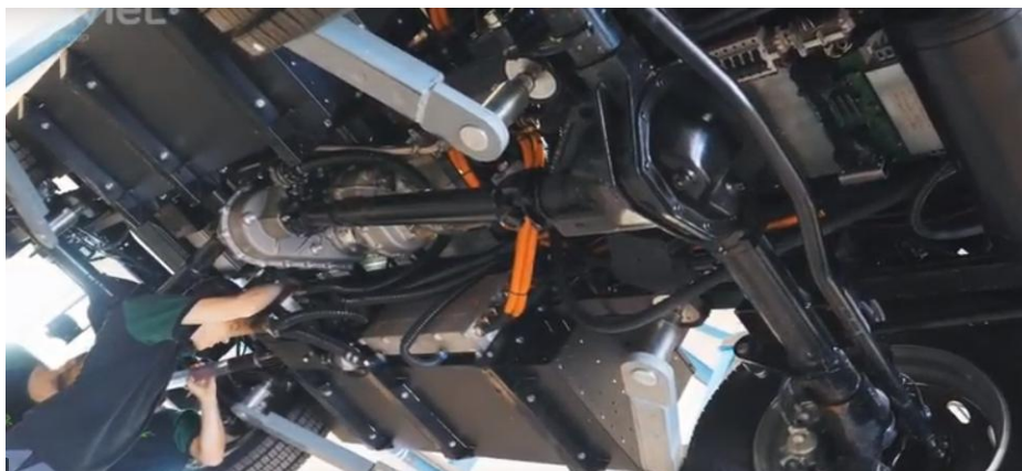
Obr. 11: Pohonné ústrojí elektromobilu Enviel [3]
