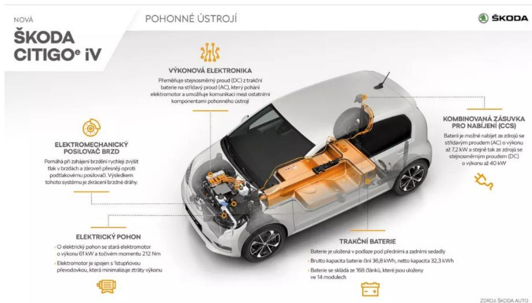
Obr. 4: Pohonné ústrojí škody Citigo iV [11]
