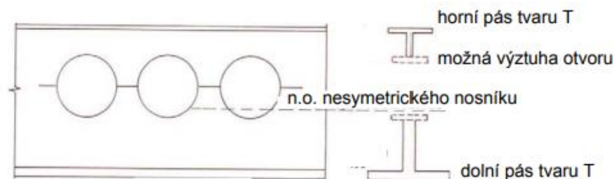
Obr. 51.: Prolamovaný nosník svařen z pásů [18]
