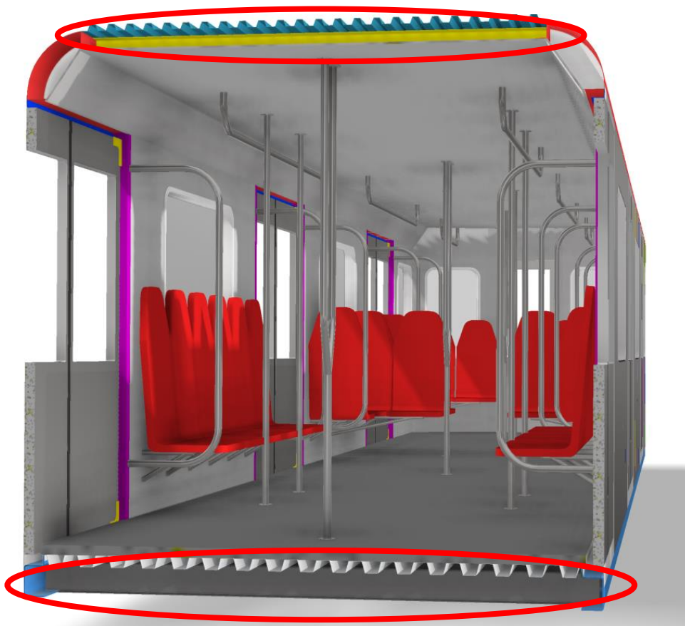
Obr. 112.: Zvýraznění nejvýhodnějších míst pro vytvoření odlehčovacích otvorů
