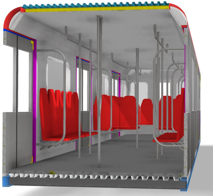
Obr. 82.: Příčný řez vozidlem s vyobrazeným interiérem a obložením
