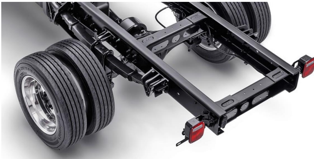
Obr. 38.: Otvory vytvořené v U profilech rámu vozidla Chevrolet Silverado [20]
