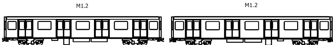
Obr. 10.: Schéma vložených vozů metra
