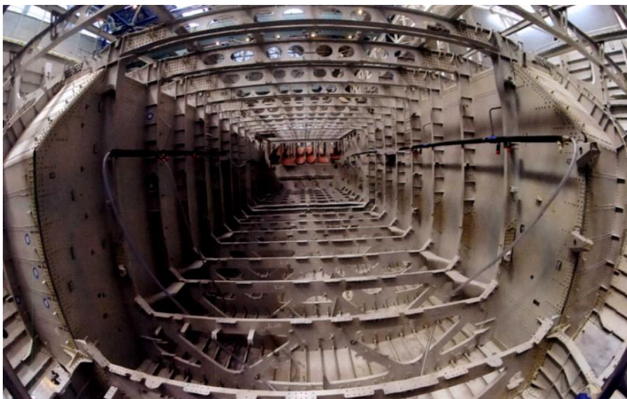
Obr. 40.: Část ocelové konstrukce Airbusu A380 zvyšující tuhost konstrukce [21]
