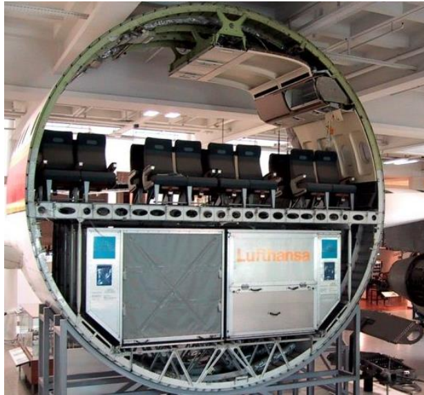
Obr. 39.: Řez trupem letadla A300, příčnky podlahy mají patné odlehčení podobně jako rám automobilu a kolejových vozidel [21]
