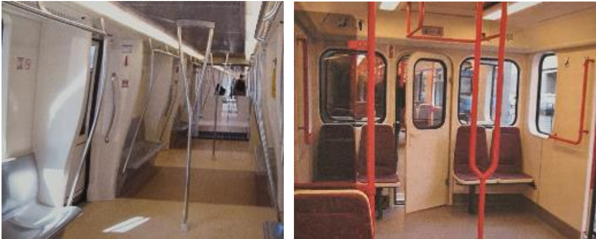
Obr. 25.: Interiér metra pro Řím s nerezovými madly a plastovými sedačkami, pražské metro čalouněné sedačky a povrchově upravená madla [6]
