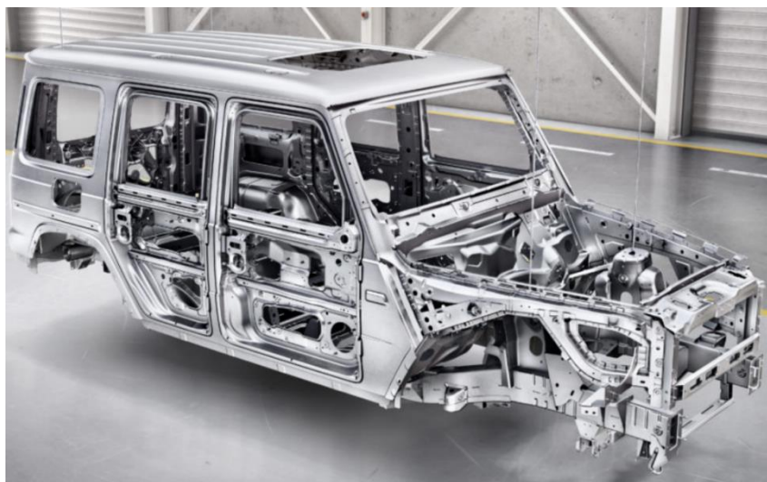
Obr. 36.: Pohled na samonosnou karosérii vozu mercedes G, odlehčovací otvory jsou patrné na výztuhách dveří [19]
