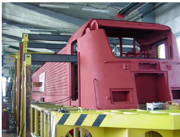
Obr. 91.: Ukázka statických zkoušek skříně kolejového vozidla [12]
