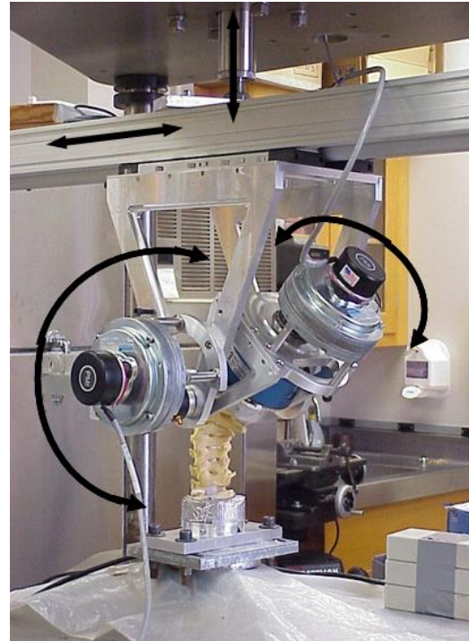
Obrázek 10 - Programovatelný robot vyvinutý k zatěžování páteří prostým ohybem, stupně volnosti jsou vyznačeny černými šipkami [26]
