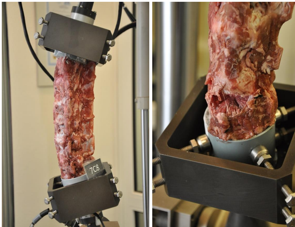
Obrázek 17 – Detailní záběr upnutého vzorku páteře (nalevo) a vzorku páteře, u které došlo při ohybu k destrukci (napravo)
