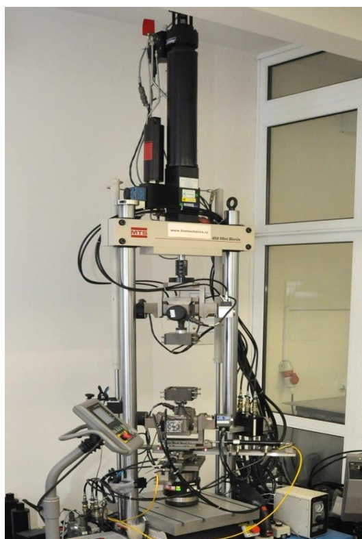
Obrázek 12 – Testovací zařízení MTS Mini Bionix 858.2 se spinálním simulátorem
