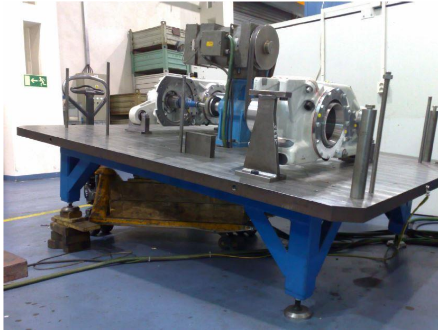
Obr. 6.: Naklonění převodovky v příčném směru [2]
