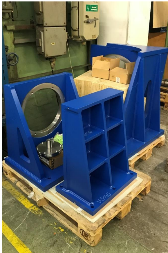
Obr. 91.: Díly pro zkušební zařízení s dutou hřídelí
