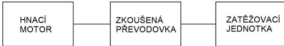
Obr. 15.: Schéma otevřeného okruhu
