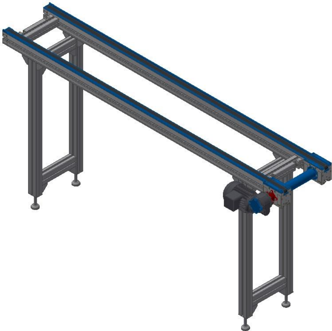
Obrázek č. 65: Model dopravníku o délce 2000 mm a šířce 320 mm
