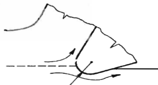
Schéma 3 tečení materiálu u ostří [4]
