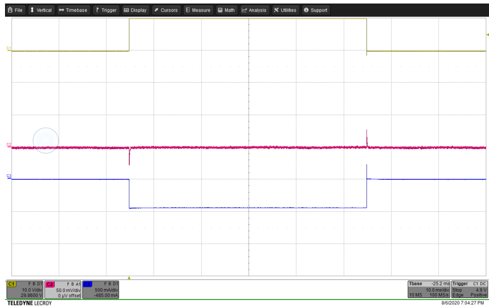
Obrázek A.2: Výstupní veličiny lineárního stabilizátoru při U_o = 5\text{ V} a \Delta I_o = 0.4\text{ A} , C1–10 V/div, C2–50 mV/div, C3–500 mA/div, t –10 ms/div
