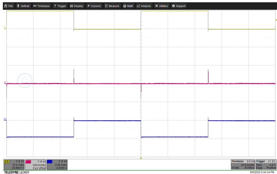
Obrázek A.3: Výstupní veličiny lineárního stabilizátoru při U_o = 5\text{ V} a \Delta I_o = 2\text{ A} , C1–10 V/div, C2–100 mV/div, C3–2 A/div, t –20 ms/div
