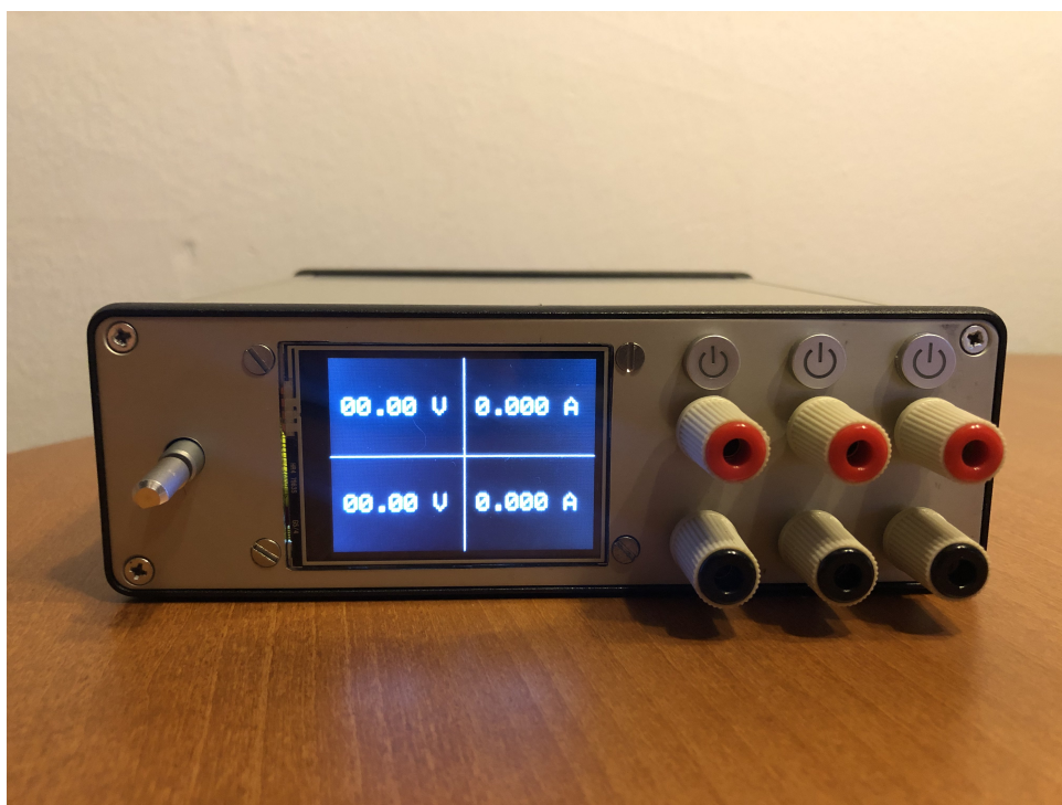
Obrázek 4.15: Fotografie realizovaného prototypu laboratorního zdroje
