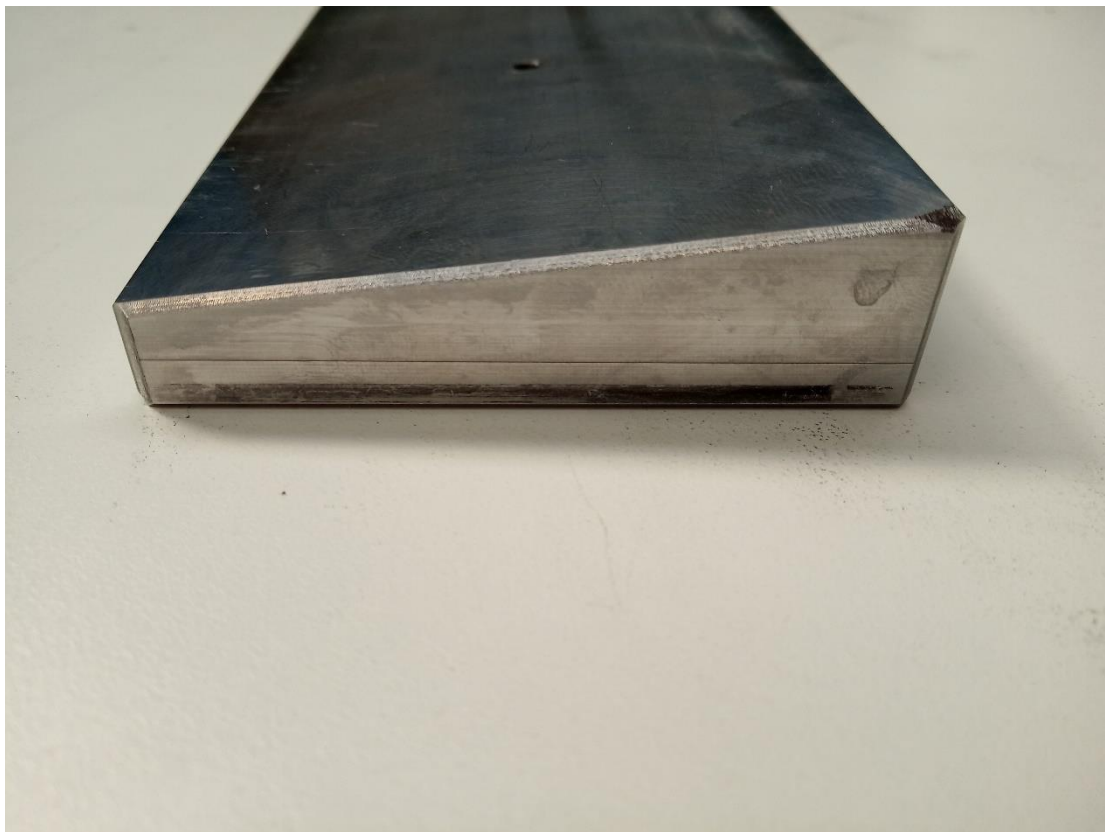
Obrázek 11 - Zkosený upínací přípravek pro broušení ostří
