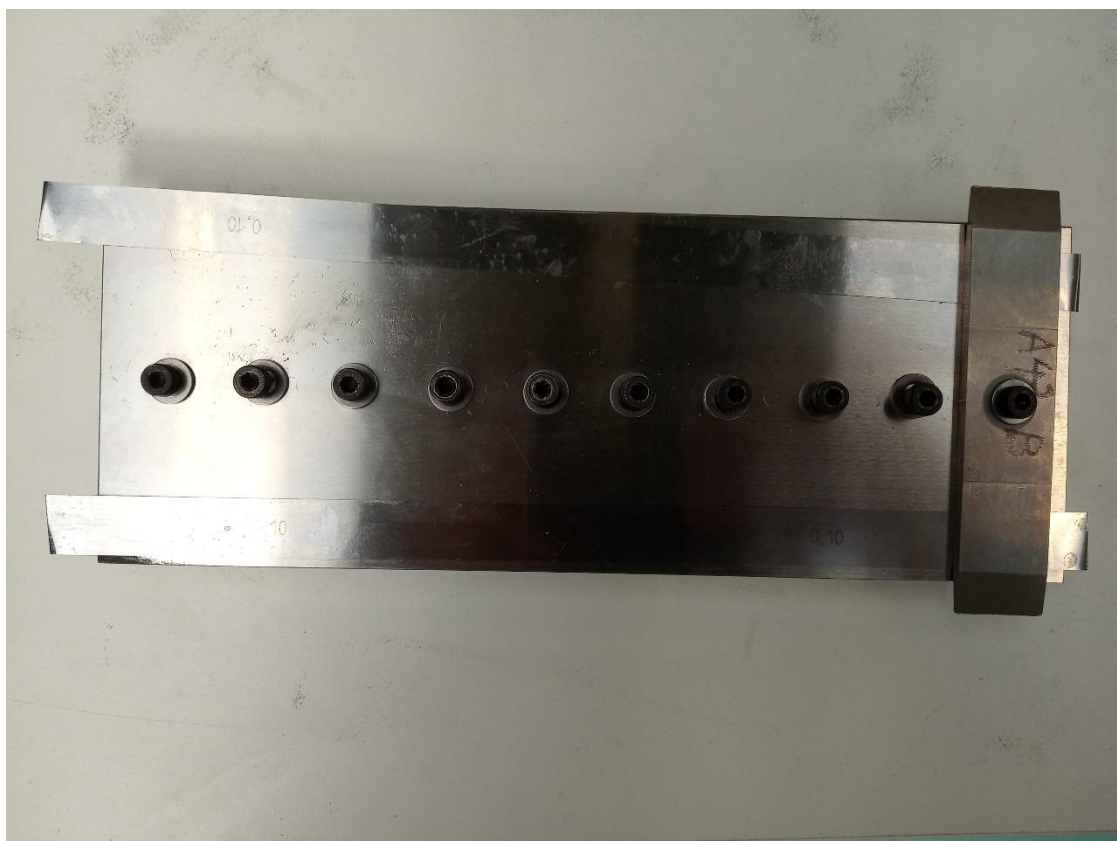
Obrázek 12 - Rovný upínací přípravek s podkládacími planžetami
