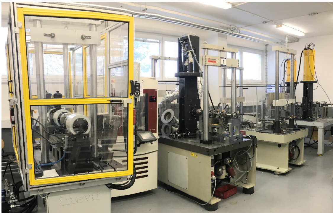
Obrázek 12: Stroje pro zjišťování únavových vlastností ve firmě Mubea s.r.o.
