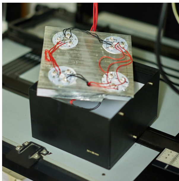
Obrázek 3.3: Deska s LED články a box původního difuzoru (převzato [9])
