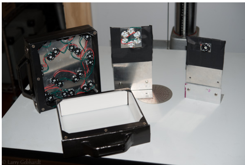
Obrázek 3.4: Jednotlivé konfigurace světelného zdroje, (zleva) vícebodový zdroj světla s variabilním nastavením gradace, simulace jednobodového zdroje světla s variabilním nastavením gradace, jednobodový zdroj světla bez variabilního nastavení gradace (převzato [10])
