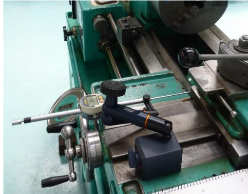
Obrázek 81 Měření polohování digitálním úchylkoměrem
