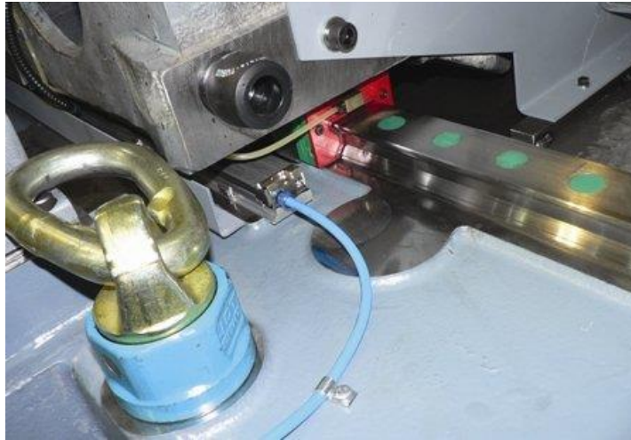
Obrázek 17 Přívod stlačeného vzduchu do snímače [13]
