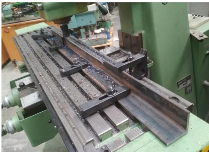
Obrázek 56 Výroba podpůrné lišty, systém upnutí obrobku
