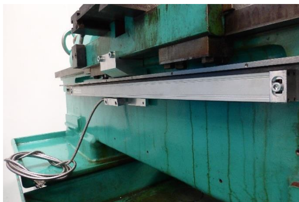
Obrázek 71 Montáž podpůrné desky a pravítka
