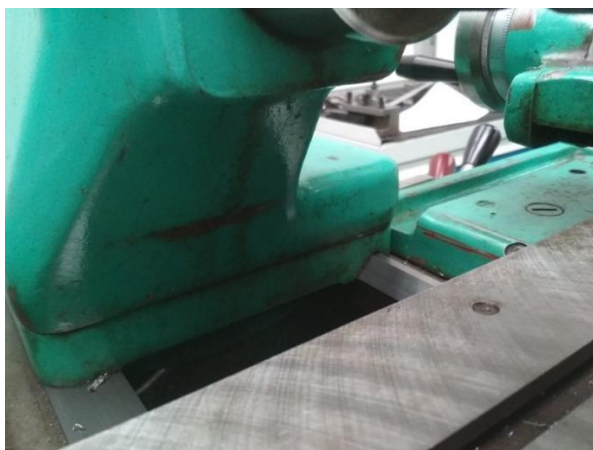
Obrázek 41 Přední strana koníku poškozená neopatrnou manipulací
