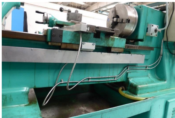
Obrázek 78 Připevnění kabelů na zadní straně stroje
