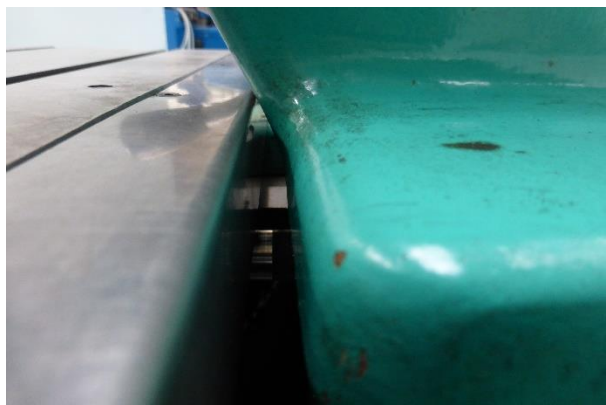
Obrázek 55 Vůle vymezená nárazníkem mezi koníkem a suportem
