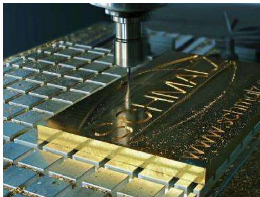
Obr. č. 18 – Gravírování při upnutí na vakuové desce [4]
