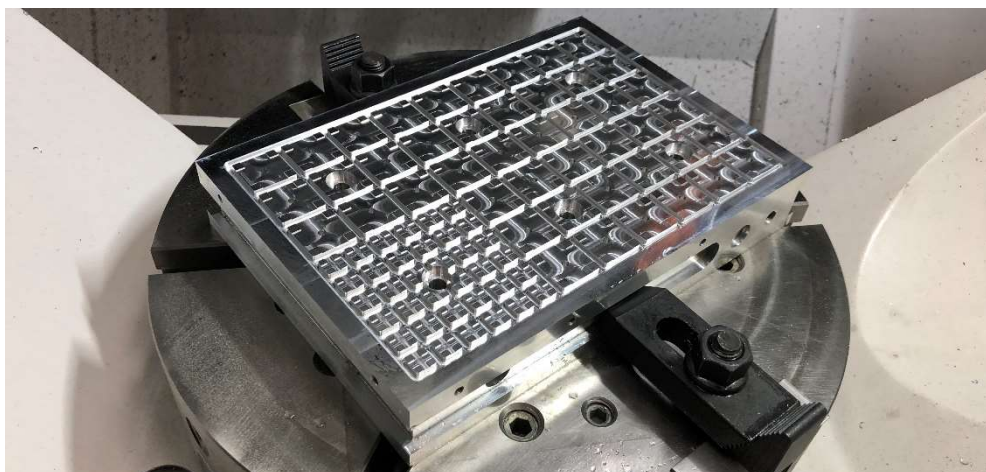
Obr. č. 75 – Stav po dokončení obrábění vrchního rastru
