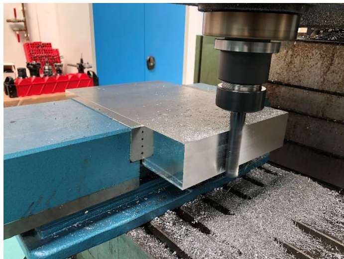
Obr. č. 61 – Obrábění kratších boků po celé délce
