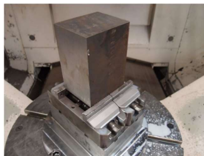
Obr. č. 2 – Aplikace strojního svěráku [32]
