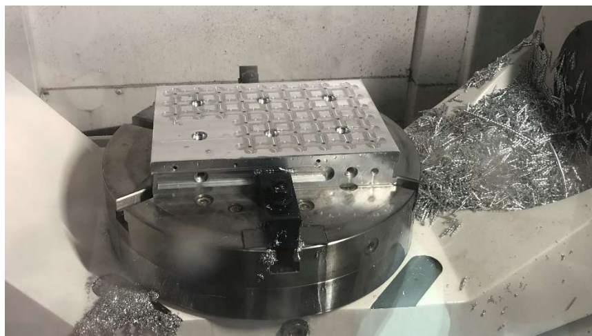
Obr. č. 71 – Stav po vybrání dosedacích ploch
