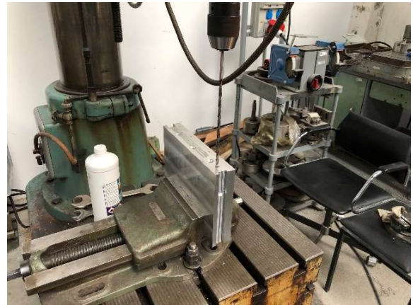
Obr. č. 63 – Vrtání dlouhých děr
