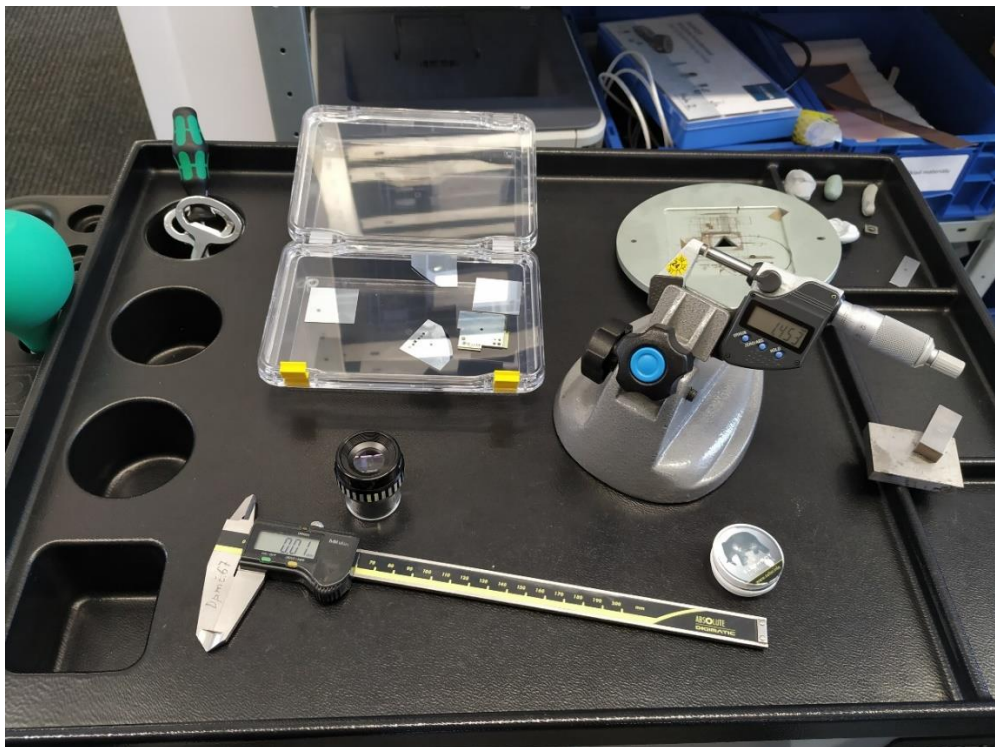
Obr. 31 - Měření skutečných rozměrů polotovaru
