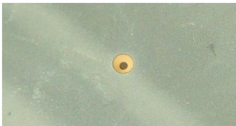
Obr. 35 - Detail kuželové díry v křemíkovém substrátu
