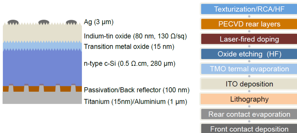
Obr. 6: Schematické znázornění struktury solárního článku s heteropřechodem kombinujícího TMO a c-Si typu N (vlevo) a procesní diagram postupu při výrobě článku tohoto druhu (vpravo) [29]
