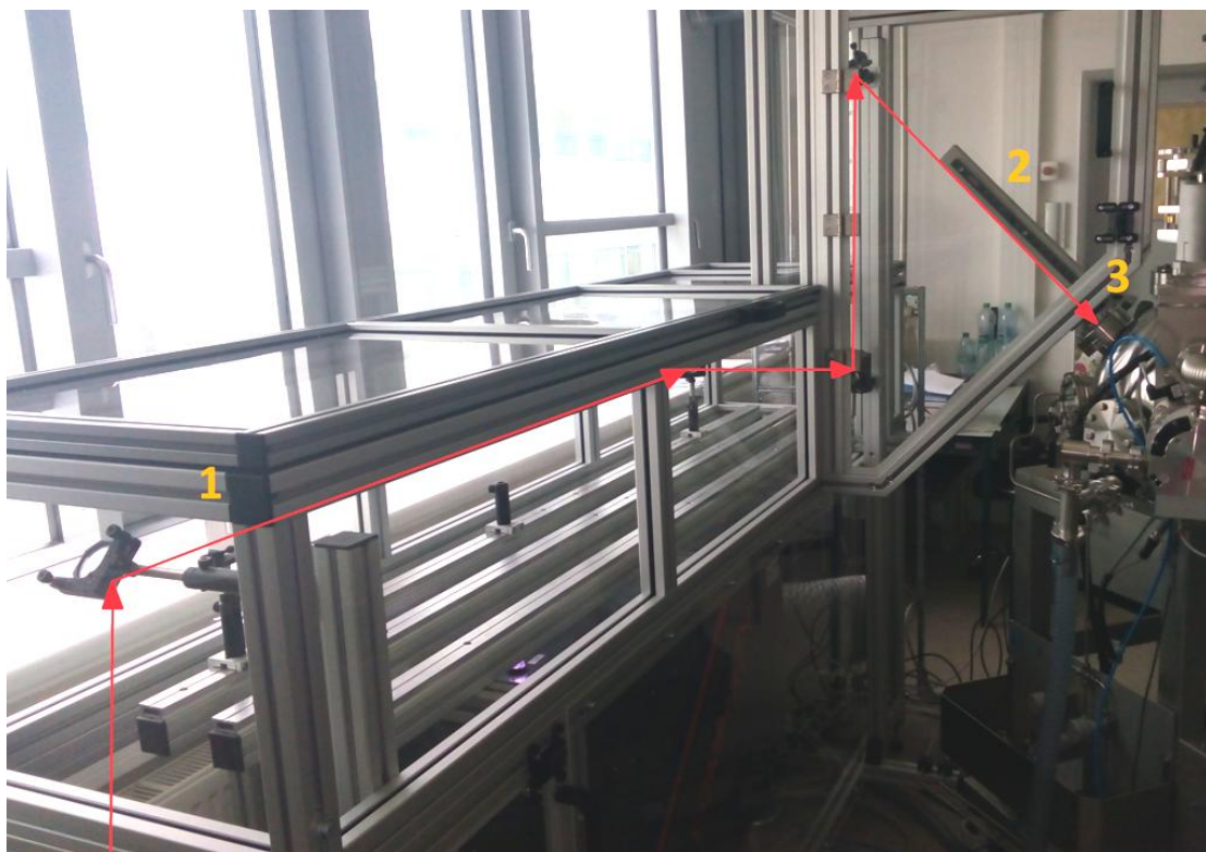
Obr. 9: Fotografie optické dráhy laseru PLD zařízení, červenou čarou se šipkami je vyznačena dráha laserového paprsku, oranžovými číslicemi pak apertura (1), stupnice poslední čočky (2) a poslední čočka (3)
