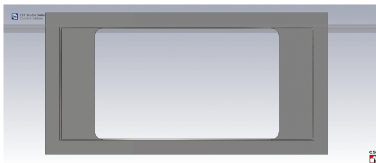
Obrázek 3.13. Možná podoba clonkové diskontinuity zužující z obou stran vlnovod.
