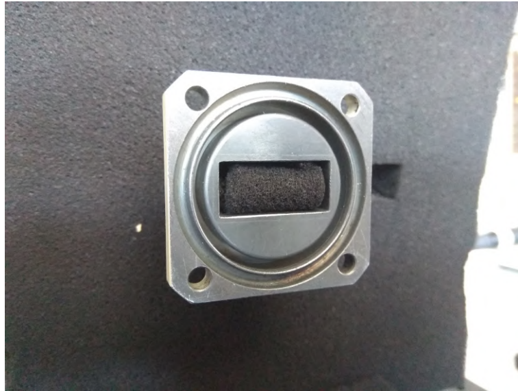
Obrázek 4.6. Atenuátor ve vlnovodu realizovaný útlumovým materiálem.
