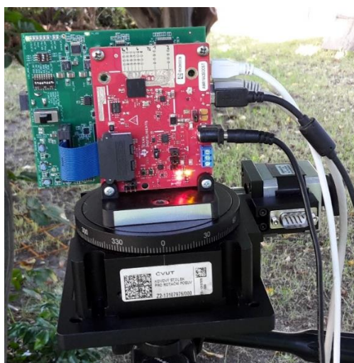
Obr. 9.8: Radar AWR1642BOOST s připojenou sběrnou kartou DCA1000EVM umístěný na elektronicky ovládané azimutální točce
