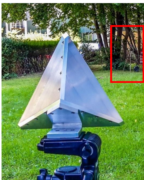
Obr. 9.9: Pohled směrem k vyznačenému radaru od koutového odražeče s RCS 100 \text{ m}^2 umístěného ve vzdálenosti 20 m
