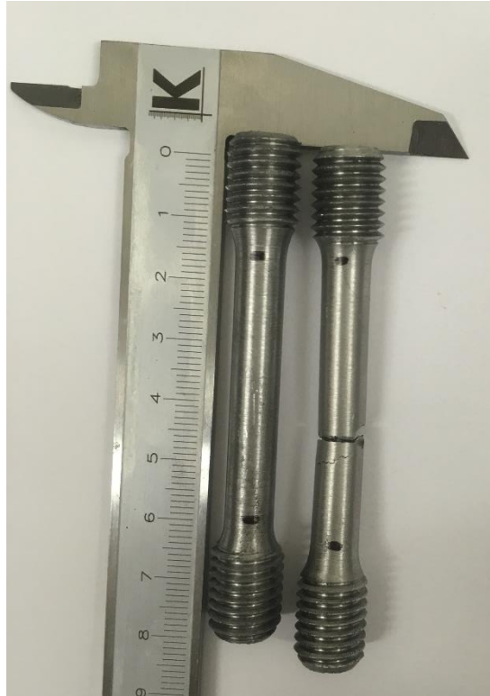
Obr.13 – zkušební vzorek pro zkoušku tahem 3D tištěné slitiny AlSi10Mg; levý vzorek – před přetržením; pravý vzorek – po přetržení
