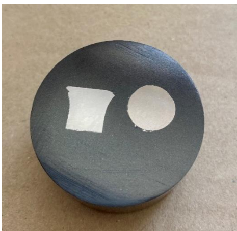
Obr.16 – metalografický vzorek 3D tištěné slitiny AlSi10Mg T2 připravený pro pozorování mikrostruktury, vlevo: podélný řez, vpravo: příčný řez
