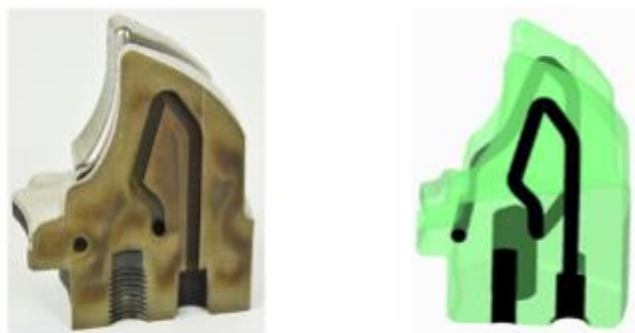
Obr.7 – segment vložky s konformním chlazením [42]
