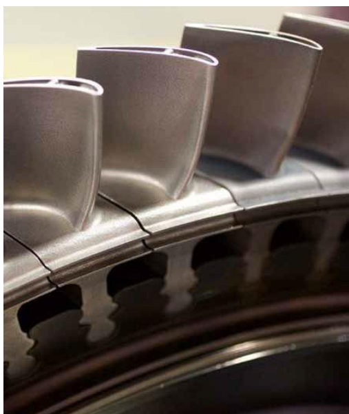
Obr.6 – 3D tištěné lopatky spalovací turbíny Siemens [40]
