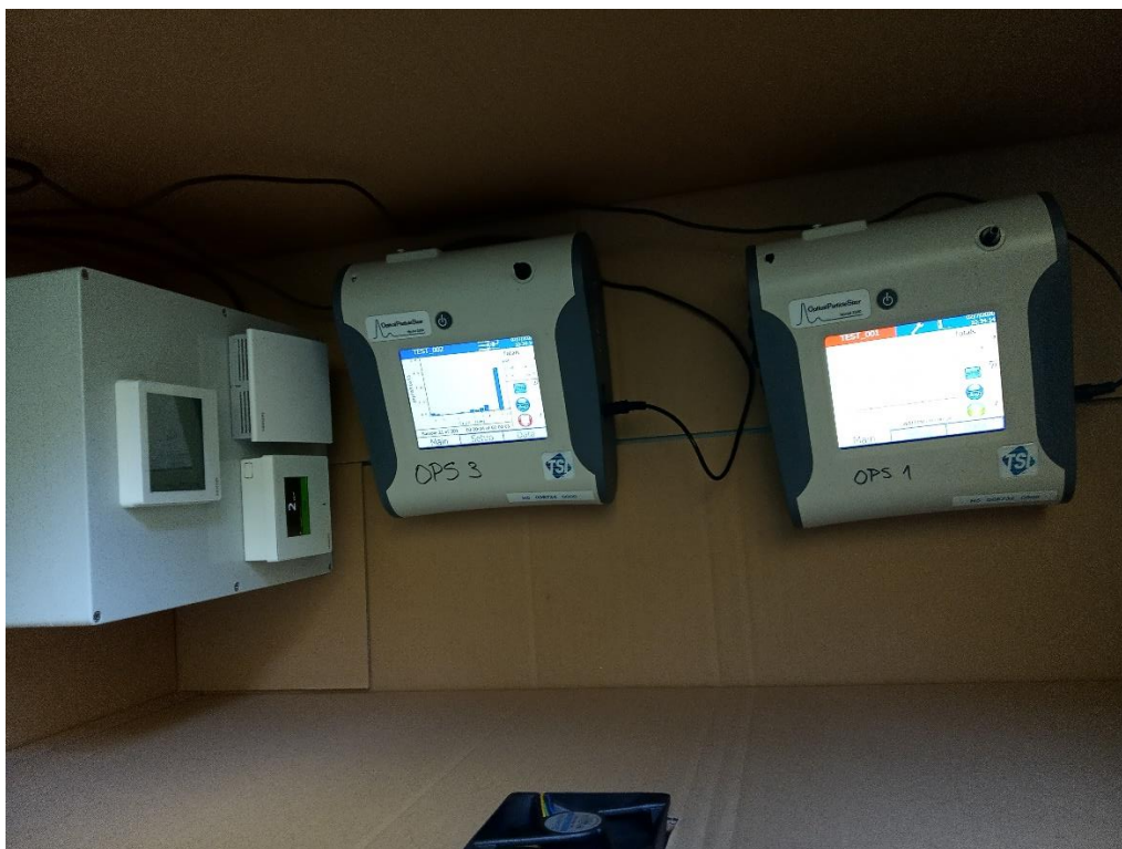
Obr. 9.5 Umístění čidla prašnosti a optických spektrometrů v měřicím boxu.
