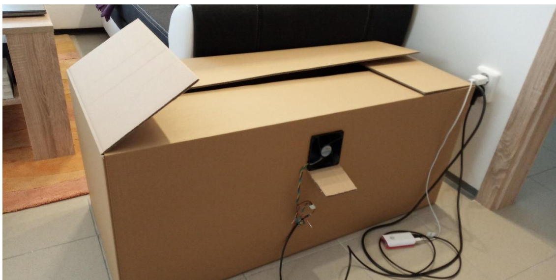
Obr. 9.4 Měřicí box pro ověření přesnosti čidla prašnosti QSAD2700D.
