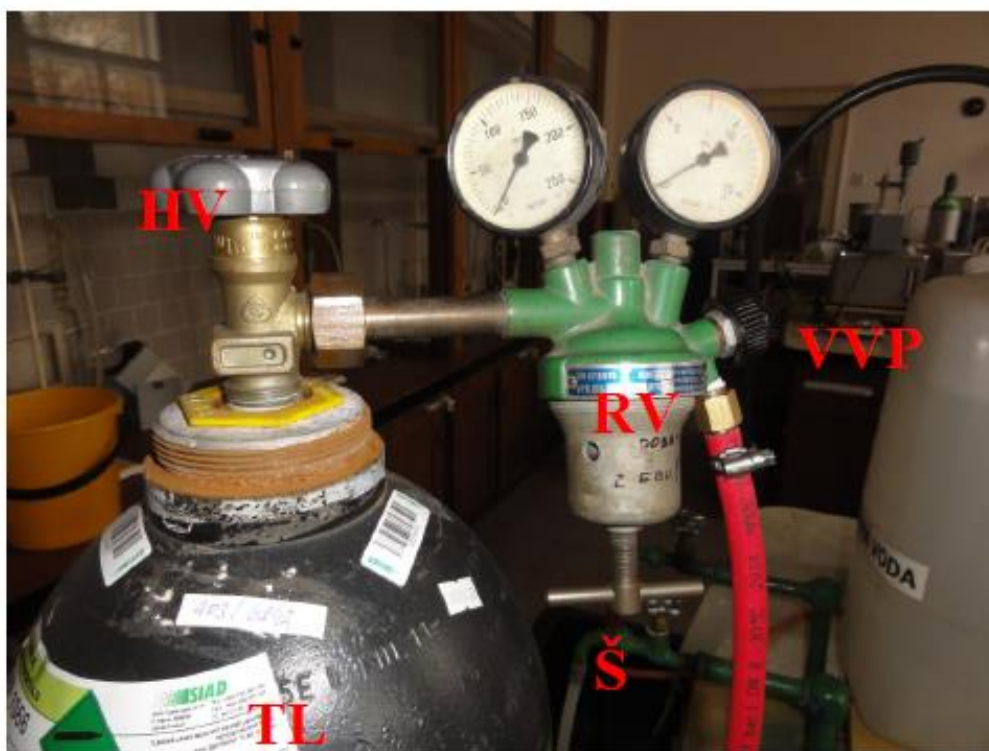
Obrázek 14. Detail redukčního ventilu RV s napojením na tlakovou lahev TL, VVP – ventil výstupního plynu o nastaveném pracovním tlaku, HV – hlavní ventil tlakové lahve, Š – šroub k nastavování pracovního tlaku [10]
