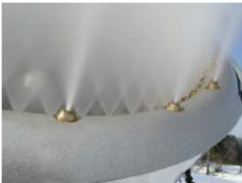
Obrázek 9. Detail trysek sněžného děla [16]
