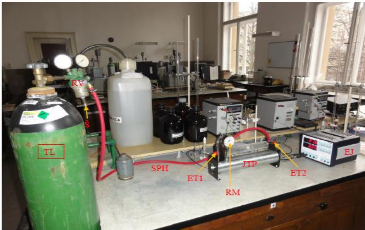
Obrázek 13. Celkový pohled na aparaturu: TL - tlaková láhev s plynem, SPH - spojovací pružná hadice, RM - ručičkový manometr, RV - redukční ventil, ET1 a ET2 - elektrické teploměry, JTP - přístroj na měření Joule-Thomsonova koeficientu [10]
