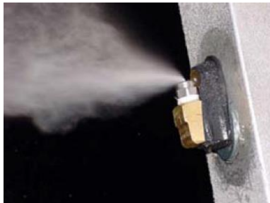
Obrázek 16. Na obrázcích je vidět tryska, kterou je vstříkována voda a otvor, kterým proudí vzduch. Na dolním obrázku je tvorba sněhu [7]
