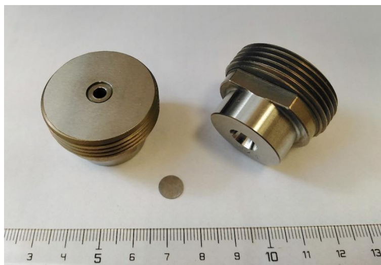
Obrázek 28: Ukázka vyrobených zápustek a zkušebního tělesa
