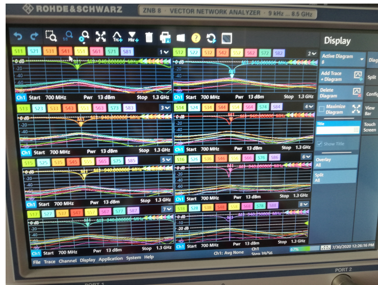
Obrázek 6.3: Rozptylové parametry celého aplikátoru s vloženým agarovým fantomem
