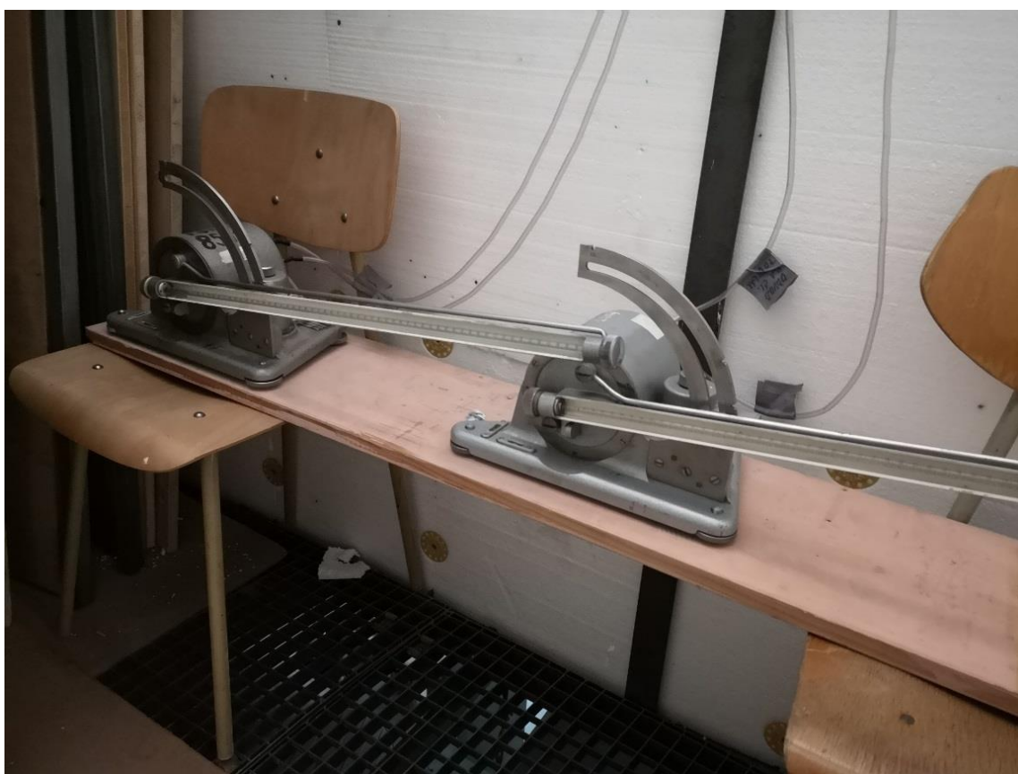
Obrázek 14 Měření rozdílu tlaků na měřicích clonách pomocí mikromanometrů
