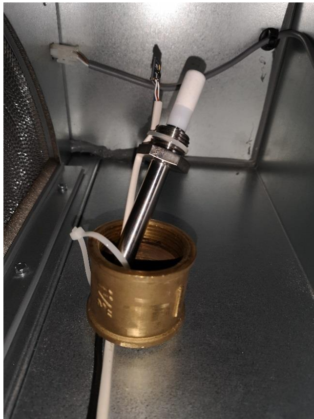
Obrázek 18 Umístění kombinovaných snímačů teploty a vlhkosti (detail)
