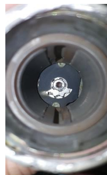
Obr.7 Výstředníkový mechanismus čerpadla
