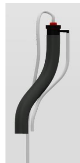
Obr.23 Hrdlo nádrže s pomocnou trubicí hladiny paliva vozu FS.12
