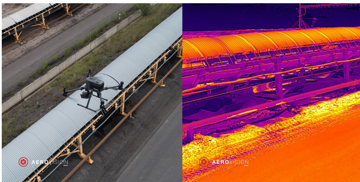
Obr. 2.11: Inspekce pásových dopravníků – Severočeské Doly a.s. (Aerovision Group 2020) Využití dronu DJI M300 RTK a termokamery H20T
