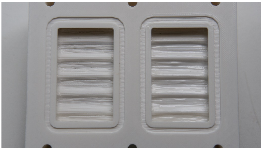
Obr. 4.10: Levá komora po hodině působení acetonových par, pravá komora po přímé aplikaci acetonu na materiál
