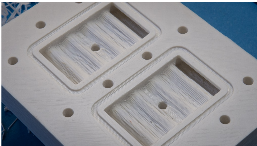
Obr. 5.1: Hrubý výtisk třetí verze kalibrátoru
