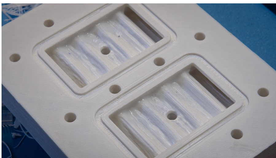
Obr. 5.2: Výtisk po aplikaci acetonu na vnitřní stěny komor
