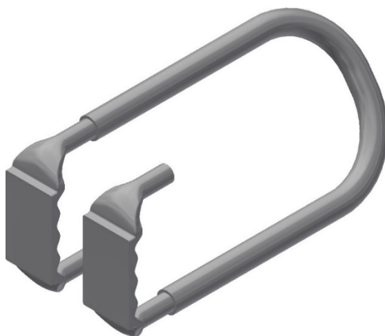
Obr. 4.17: Zjednodušený model pro návrh výpočtové sítě
