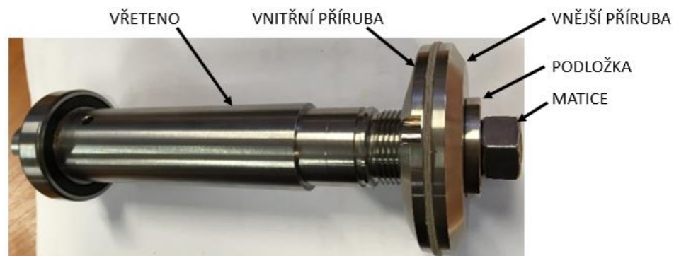
Obr. 46 Upínací rozhraní rozbrušovací pily Discotom-6
