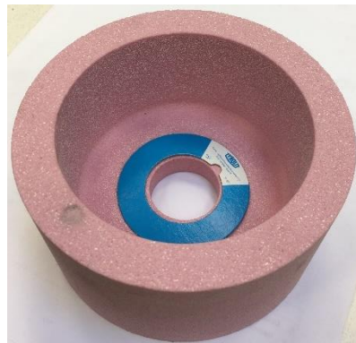
Obr. 57 Brusný kotouč TYROLIT 98A120L9V32
