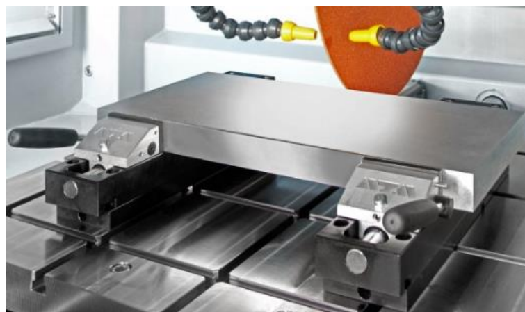
Obr. 26 Dvojitě upnutí děleného vzorku [48]
