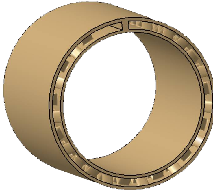
Obrázek 13: Chladicí plášť s pilířovitou strukturou (TUfast 2018) [7]
