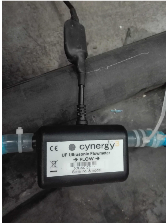
Obrázek 16: Ultrazvukový průtokoměr použitý pro měření
