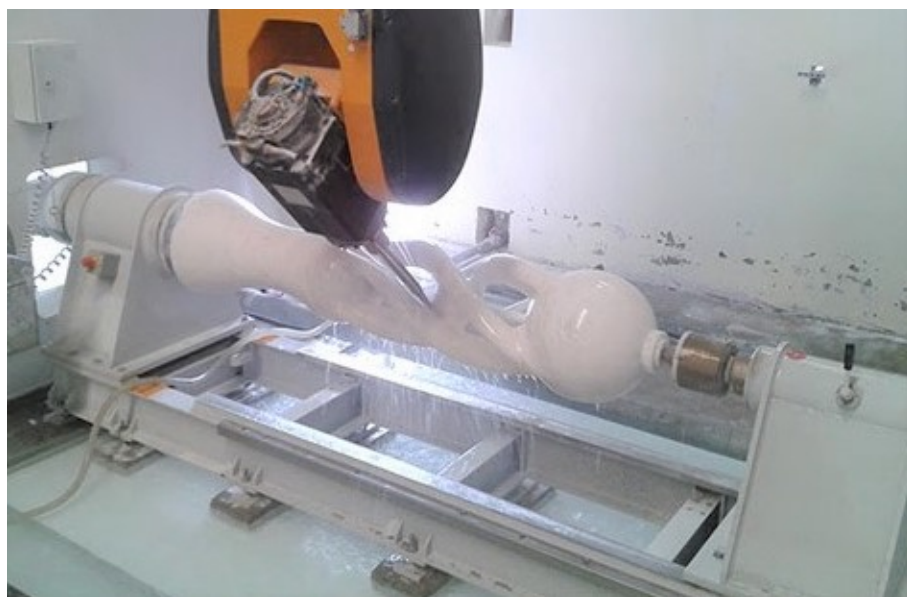
Obr. 3.2: ContourFive NC 700/1200 s nainstalovaným polohovacím zařízením [2]
