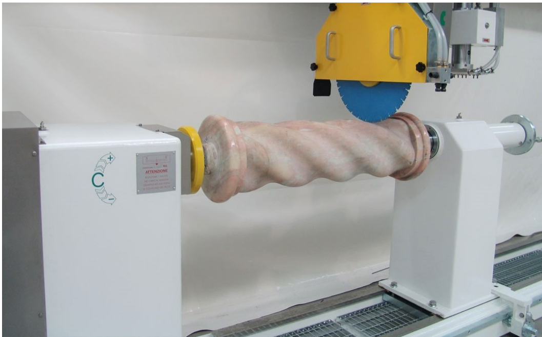
Obr. 3.6: New Dorico 1700: polohovací zařízení [12]
