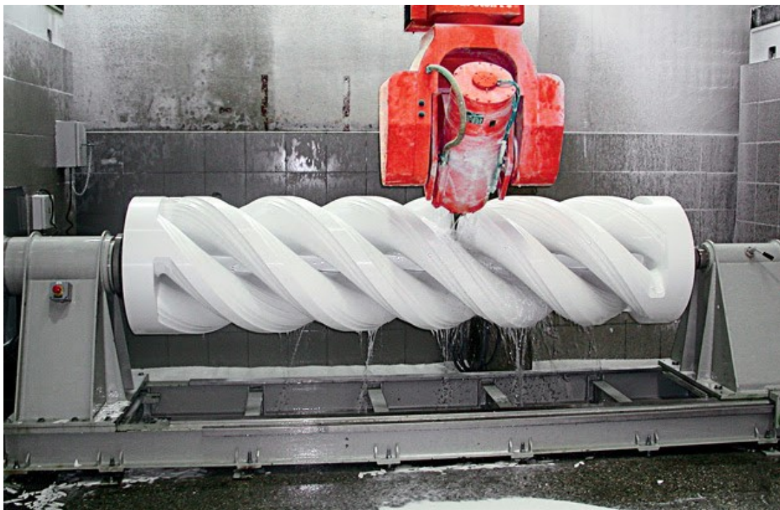
Obr. 3.4: ShapeMill NCF 1600/2000 s nainstalovaným polohovacím zařízením [6]
