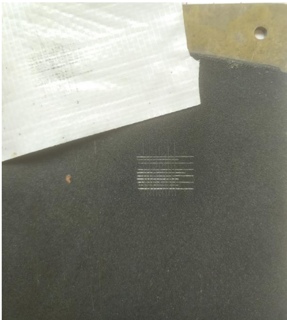
Obrázek 35 – Ocelový plech č.1 bez dalších úprav – mřížková zkouška – klasifikace 0
