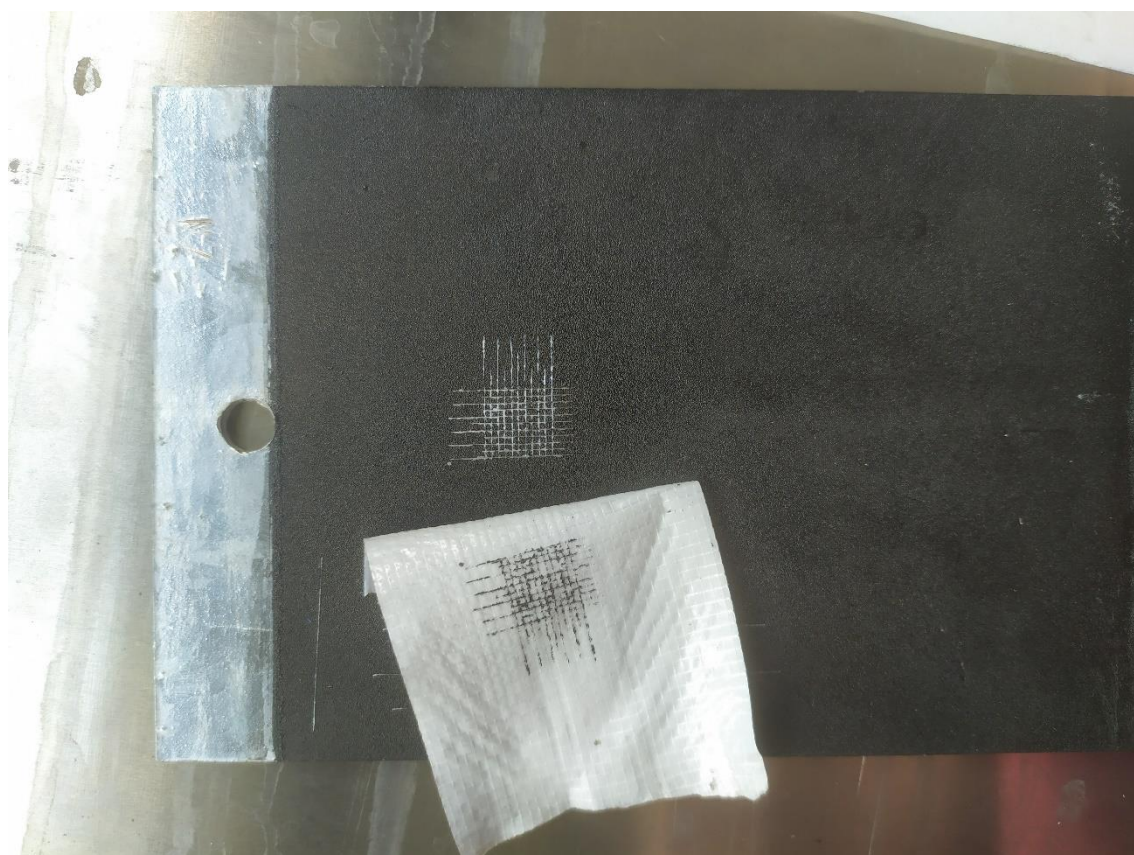
Obrázek 28 – Ocelový plech žárově zinkovaný. Zatížení 10, 12 a 15 N (zleva)
