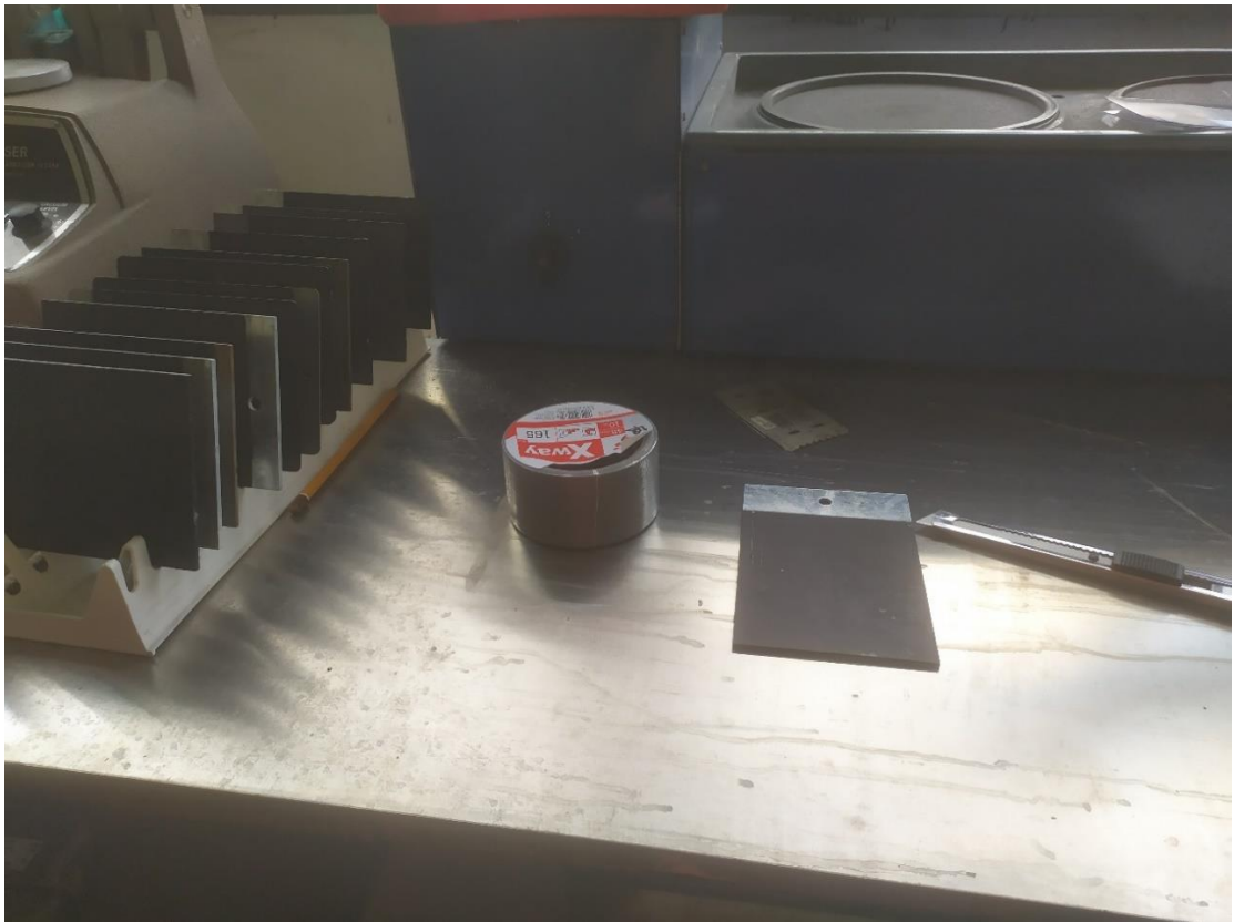
Obrázek 25 – Pomůcky pro provedení mřížkové zkoušky 1
