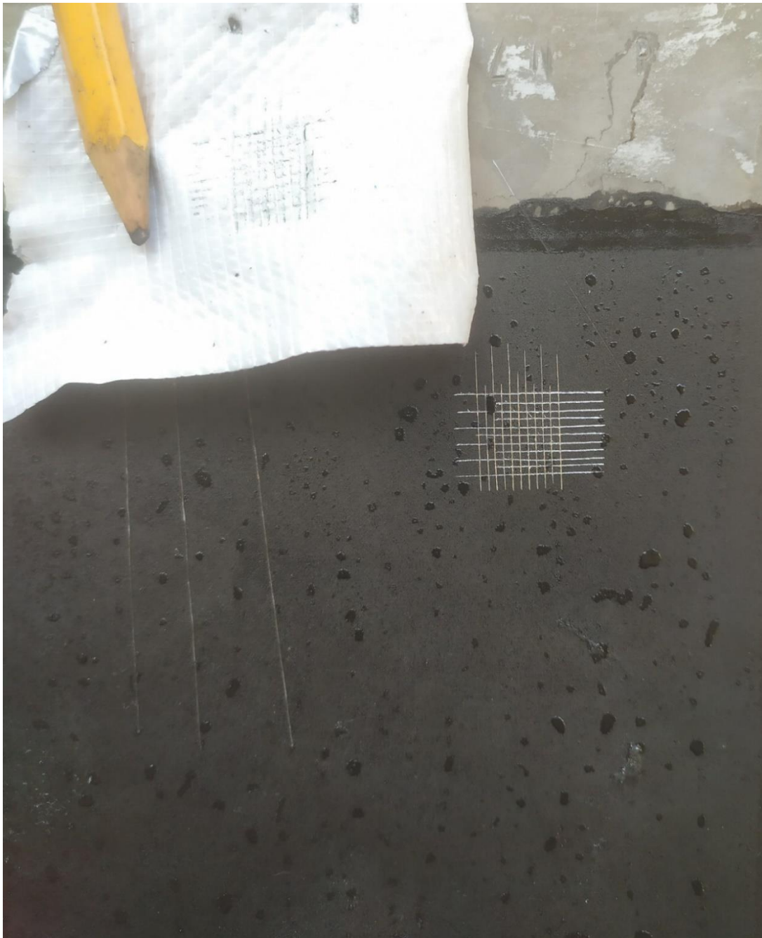
Obrázek 41 – Žárově zinkovaný plech s vrstvou fosfátu – mřížková zkouška – klasifikace 1
