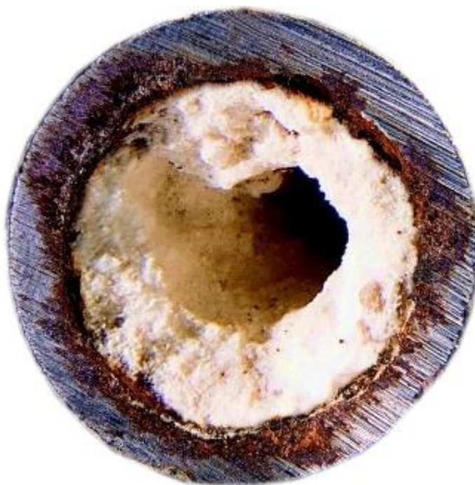
Obrázek 4. Snímek zanášení potrubí kotelním kamenem [32].
