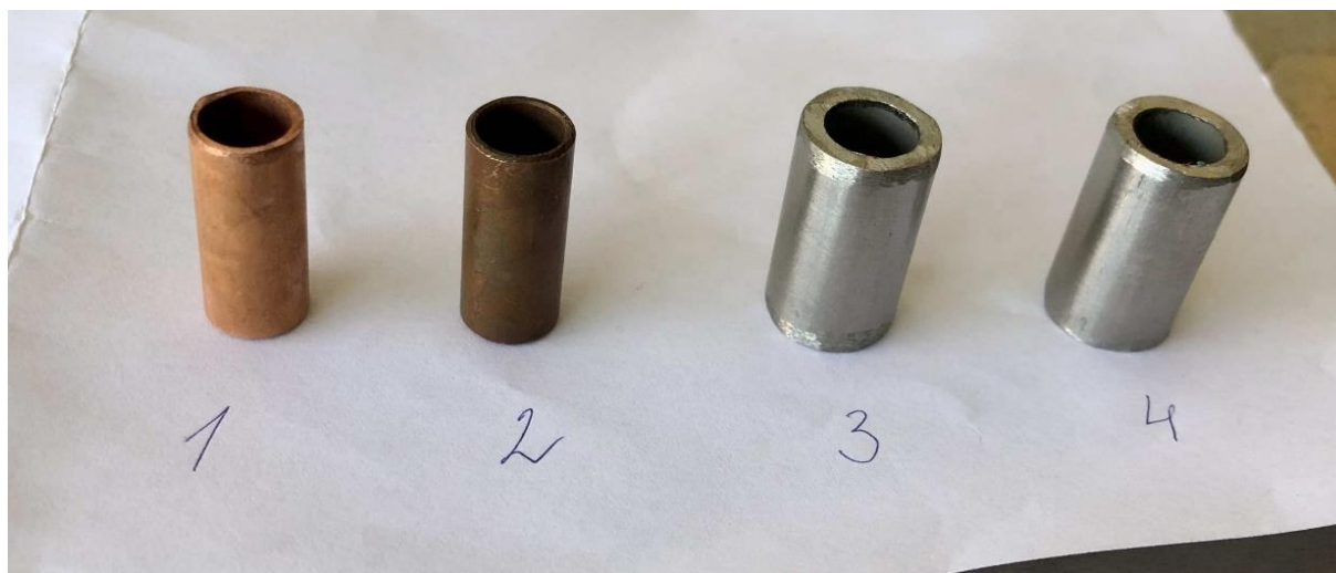
Obrázek 21. Měděné a korozivzdorné vzorky po čištění. (Při porovnání obrázků 19 a 21 je vidět, jak ostrý roztok prostředku na kyselé bázi vyčistil povrch měděné součásti.)
