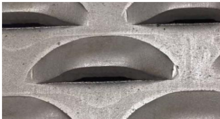
Obr. 42: Pohled na prolis ze strany střížnice
