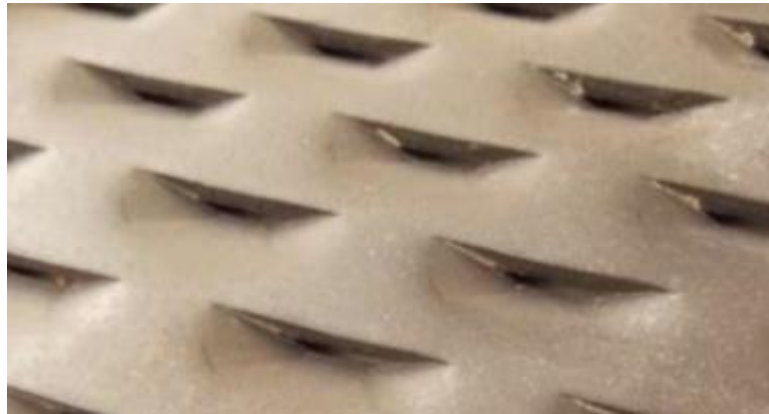
Obr. 41: Pohled na prolis ze strany střížníku
