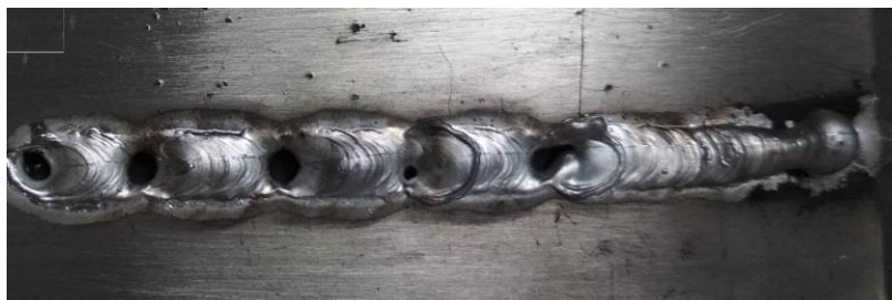
Obrázek 47 Nevydařený svarový spoj u vzorku č. 9
