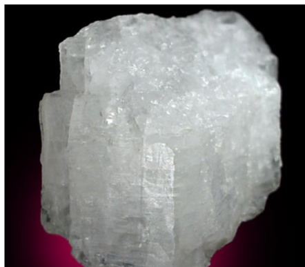
Obrázek 3 Kryolit – minerál používaný při elektrolytické výrobě Al [7]
