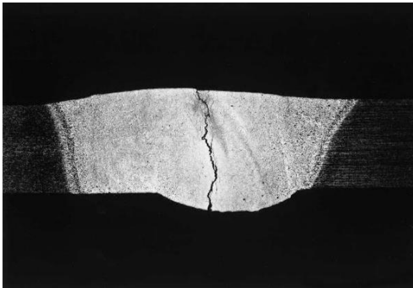
Obrázek 17 Příklad solidifikační trhliny [21]
