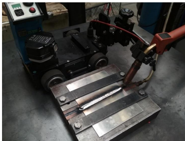
Obrázek 45 Vzorek č. 6 po zhotovení svaru
