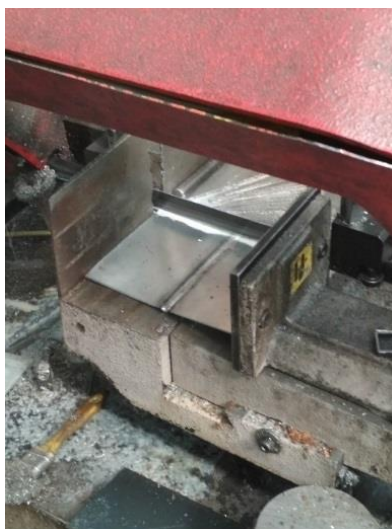
Obrázek 48 Řezání vzorku pro tahovou zkoušku
