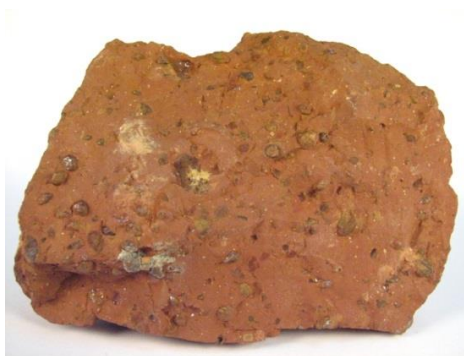
Obrázek 2 Bauxit – základní minerál pro výrobu Al [6]
