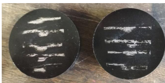
Obrázek 57 Vzorky po lisování za tepla
