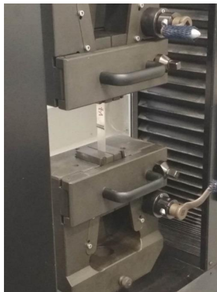
Obrázek 52 Upnutý vzorek ve zkušebním trhacím stroji
