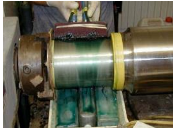
Obrázek 2 Použití lokálního pokovení pro opravu části součástky [8]
