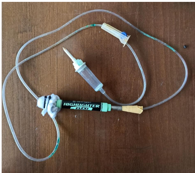
Obrázek 12 Nástroj pro pokovení připojený na přívod elektrolytu
