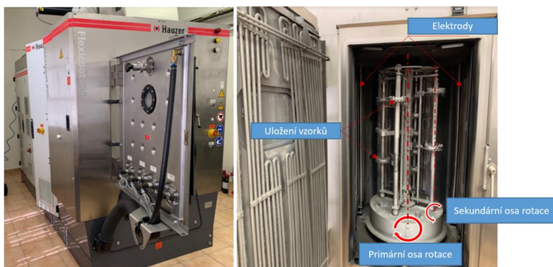
Obr. 22 Přístroj Hauzer Flexicoat 850 a pracovní komora přístroje s pomocnými prvky
