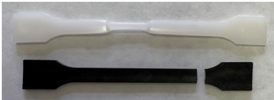
Obr. 41 Porovnání porušení materiálu C a PE-HD zkouškou tahem. V případě PE-HD je možné pozorovat vytvoření tzv. krčky, zatímco materiál C praskl křehce s minimální prodloužením.
