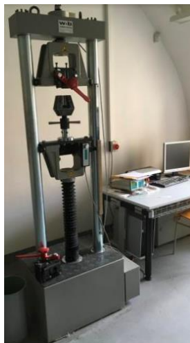
Obr. 39 ZD 10 Walter stroj pro tahovou zkoušku
