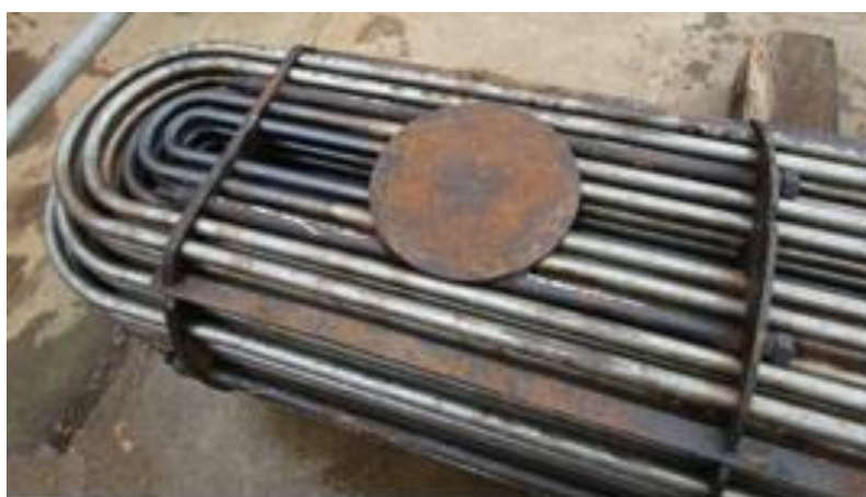
Obr. 9 - Ochranná deska, která zabraňuje korozi trubek proti vstupu trysek pláště [19]
