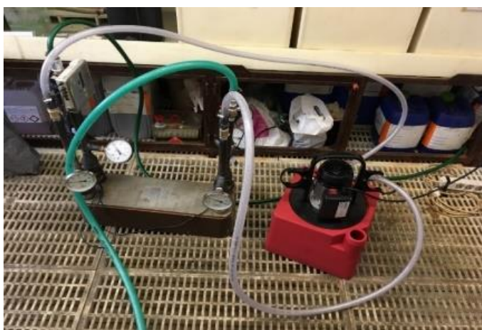
Obr. 15 - Zapojení tepelného výměníku do čistícího okruhu [38]
