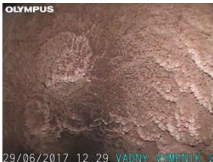
Obr. 16 - Endoskopický snímek nejvíce zanešeného místa vstupu primární strany výměníku [37]
