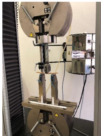
Obr. 26 – Instron 5582 s přípravkem na zkoušku ohybem.
