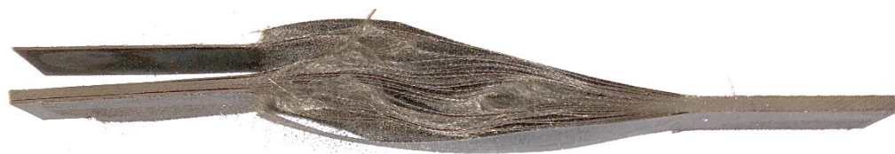
Obr. 49 – Delaminace vzorku materiálu Vetronit G11 po zkoušce tahem.
