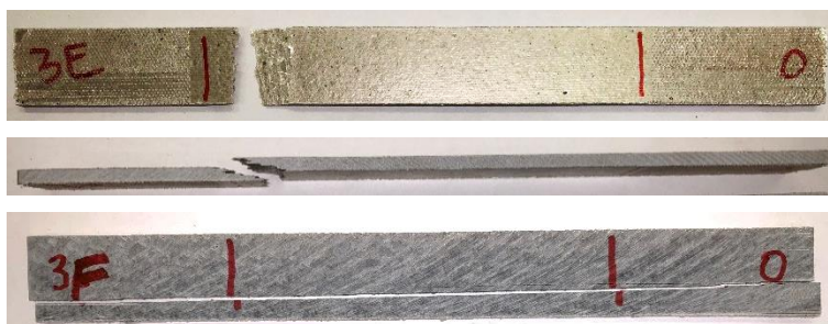
Obr. 48 - Vzorky materiálu Pamitherm 41140 po zkoušce tahem – (shora) geometrie vodorovně, geometrie vodorovně (pohled ze strany) a geometrie kolmo.
