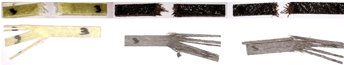
Obr. 46 – Vzorky materiálu Delmat Epoxy 68660 po zkoušce rázové houževnatosti – geometrie vodorovně (nahore) a kolmo (dole).
