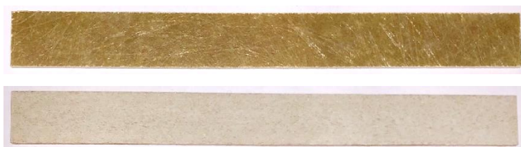
Obr. 15 – Delmat Epoxy 68660 – vyříznutý vodorovně (nahore) a kolmo (dole).
