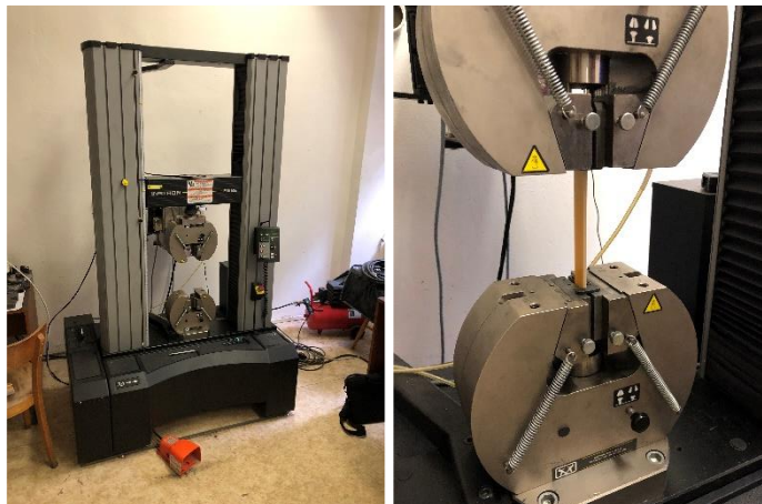
Obr. 24 – Instron 5582 přizpůsobený na tahovou zkoušku.
