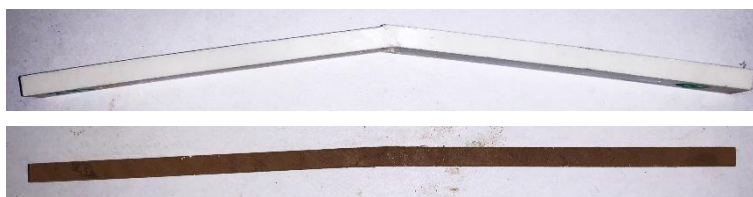
Obr. 47 - Vzorky materiálu Durapol F200 SMC po zkoušce ohybe – bez teplotního zatížení (nahore) a po teplotní expozici (dole).
