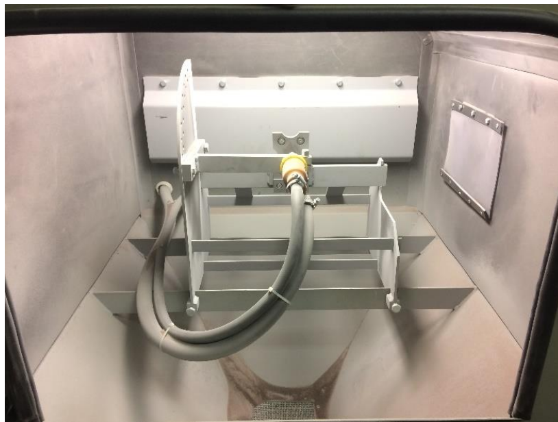
Obr. 6.19 Komora tryskacího zařízení
