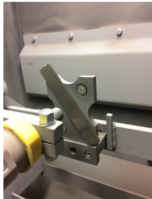
Obr. 6.15 Způsob upnutí vzorku
