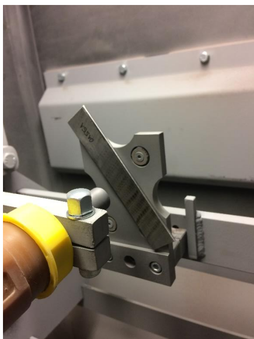
Obr. 6.20 Tryskání pod úhlem 90°
