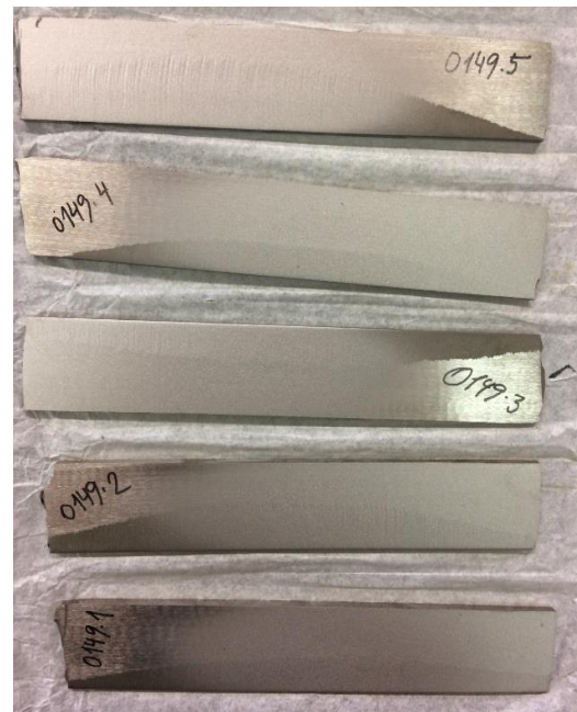
Obr. 6.24 Vzorky 0149 po tryskání – 15°
