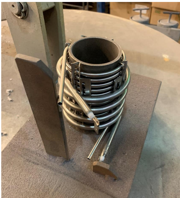
Obrázek č. 7 - Přípravek pro kontrolu geometrických vlastností spirály
