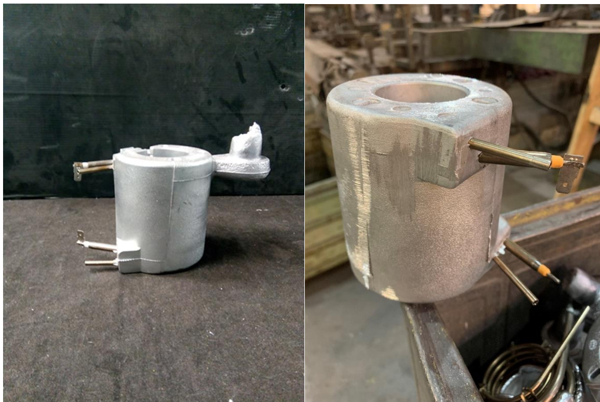
Obrázek č. 10 – a) Odlitek před apretací; b) Odlitek po apretaci
