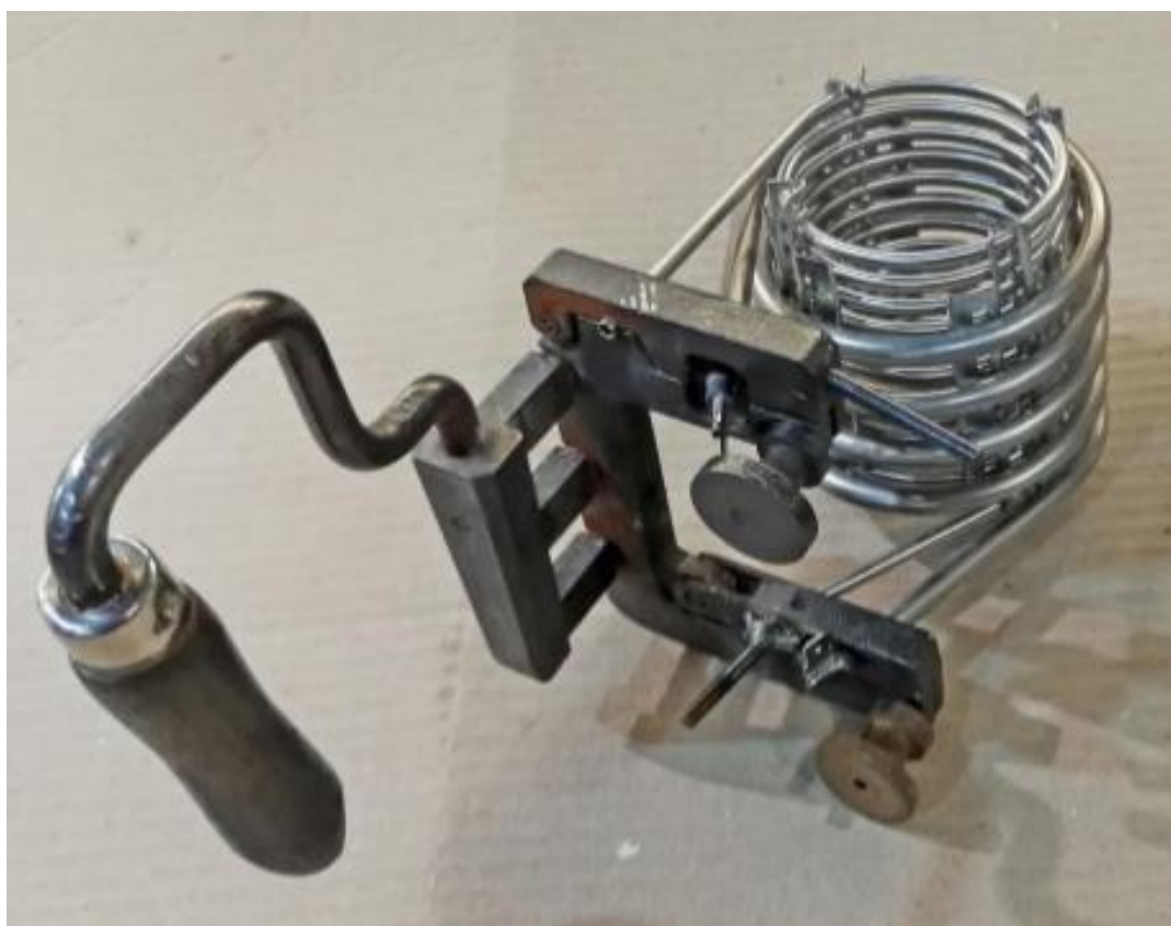
Obrázek č. 9 - Zakládací přípravek se spirálou
