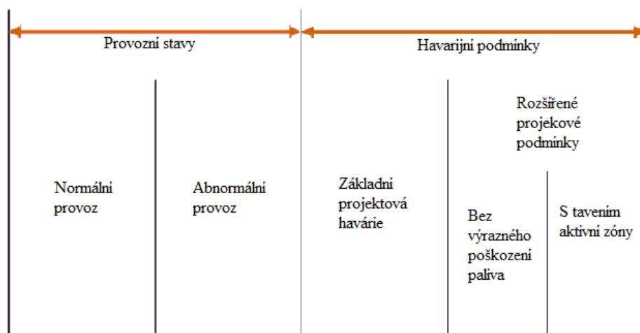
1 - Provozní stavy reaktoru [5]
