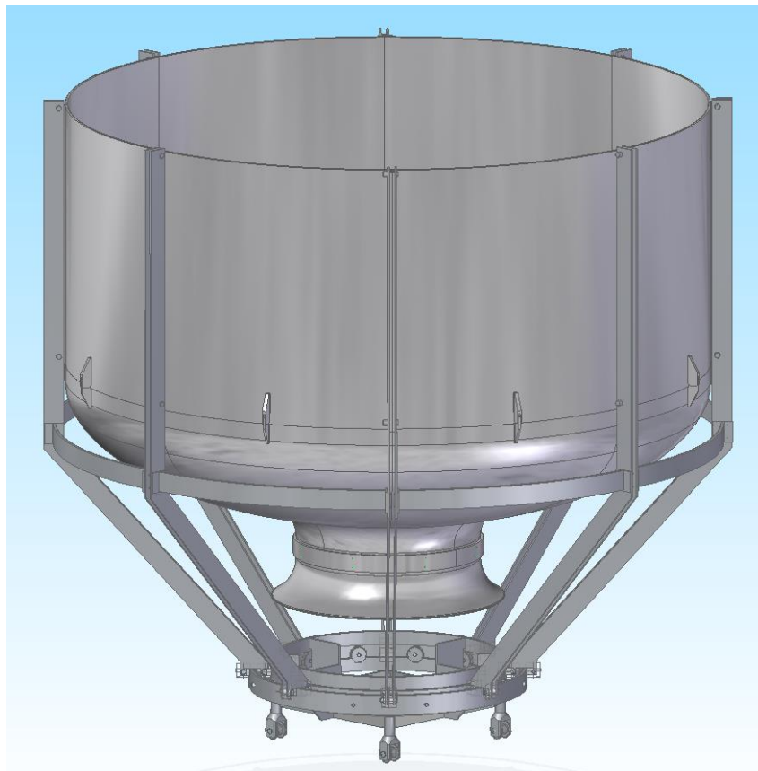
36 - model deflektoru použitelného pro reaktor VVER 1000/V320
